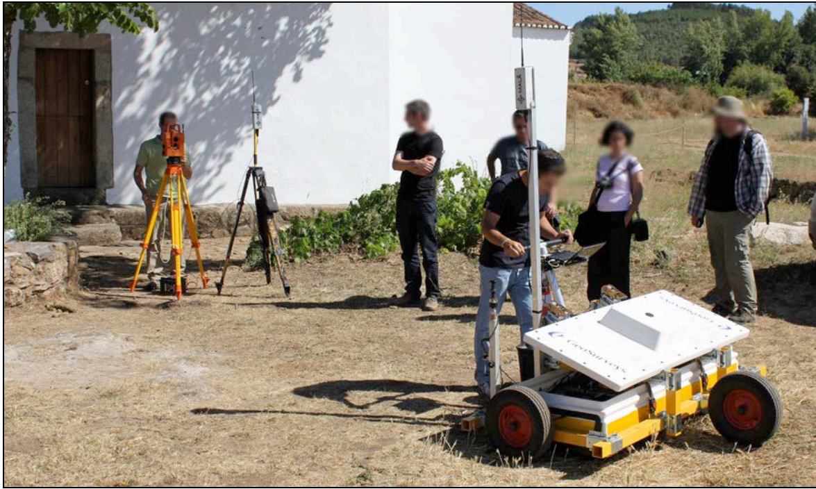
Figura 2.24 – Sistema multicanal e multiantena associado a um sistema de posicionamento por estação total (o equipamento da imagem é propriedade da empresa Geosurveys).
