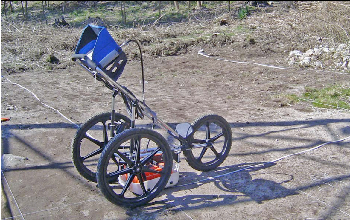
Figura 2.16 – Survey Cart modelo 623, da GSSI, equipado com o SIR-3000 e antena de 400 MHz.
