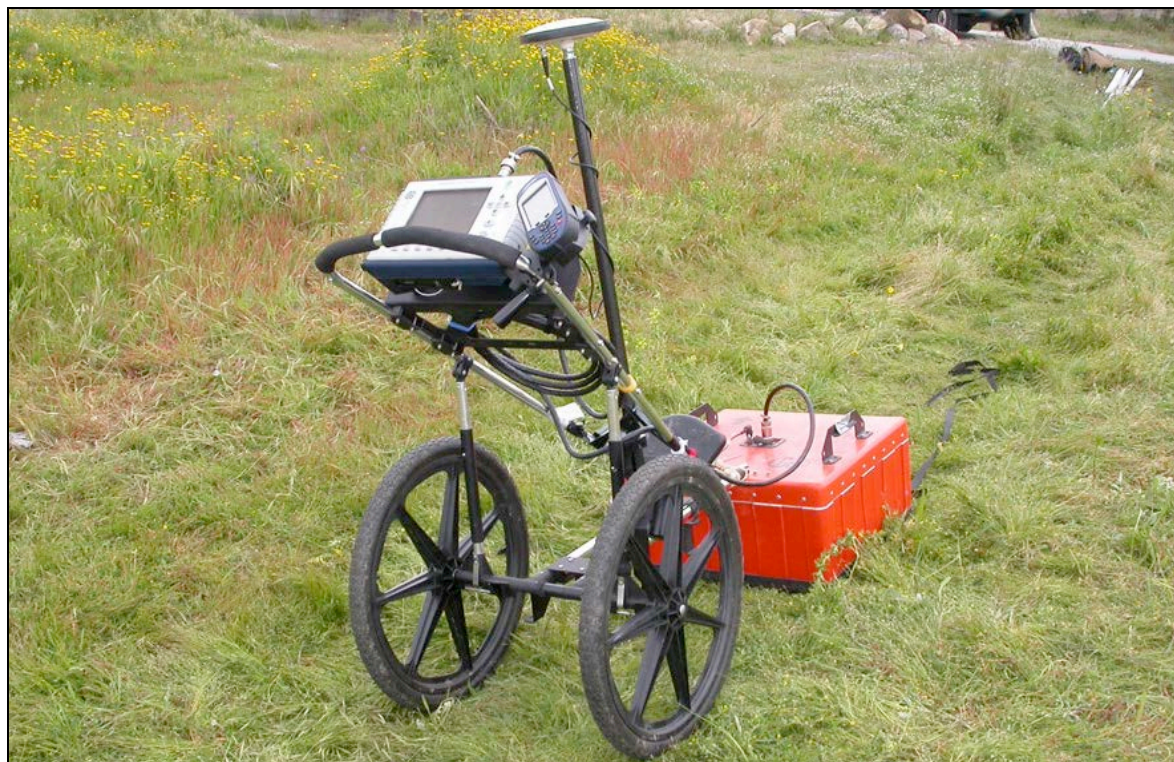
Figura 2.23 – Equipamento de Georadar da GSSI com antena de GPS diferencial da Trimble acoplada (equipamento do Centro de Ciências da terra da universidade do minho).
