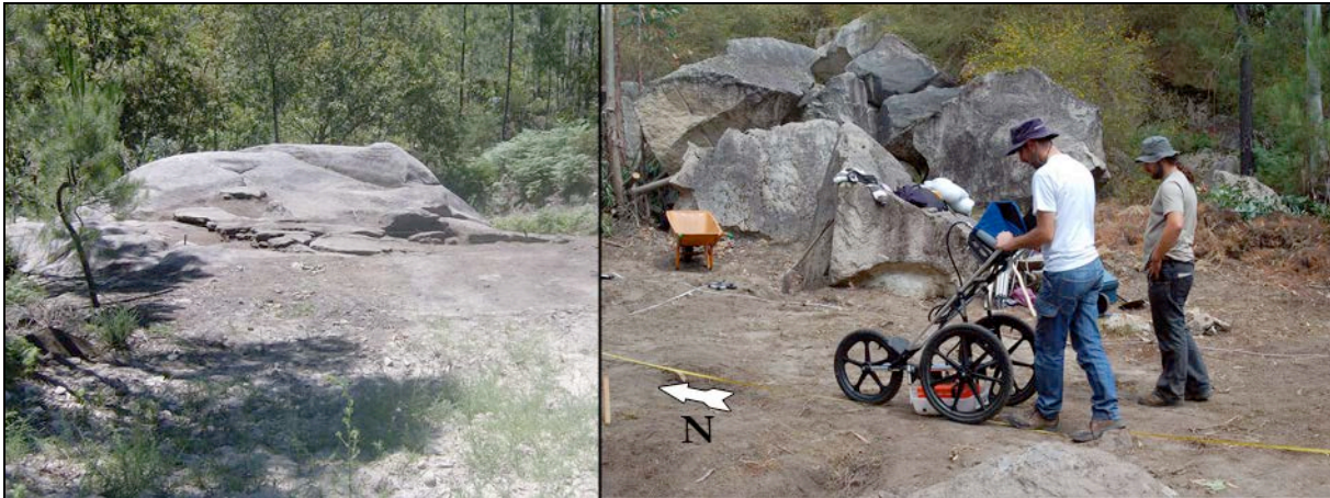
Figura 3.35 – Pormenor, à esquerda, tomado de norte da área de prospecção da grelha 1, localizado a norte da Rocha 1. Pormenor, à direita, da prospecção com o Georadar na grelha 1 (fotografias de António Pereira Dinis).
