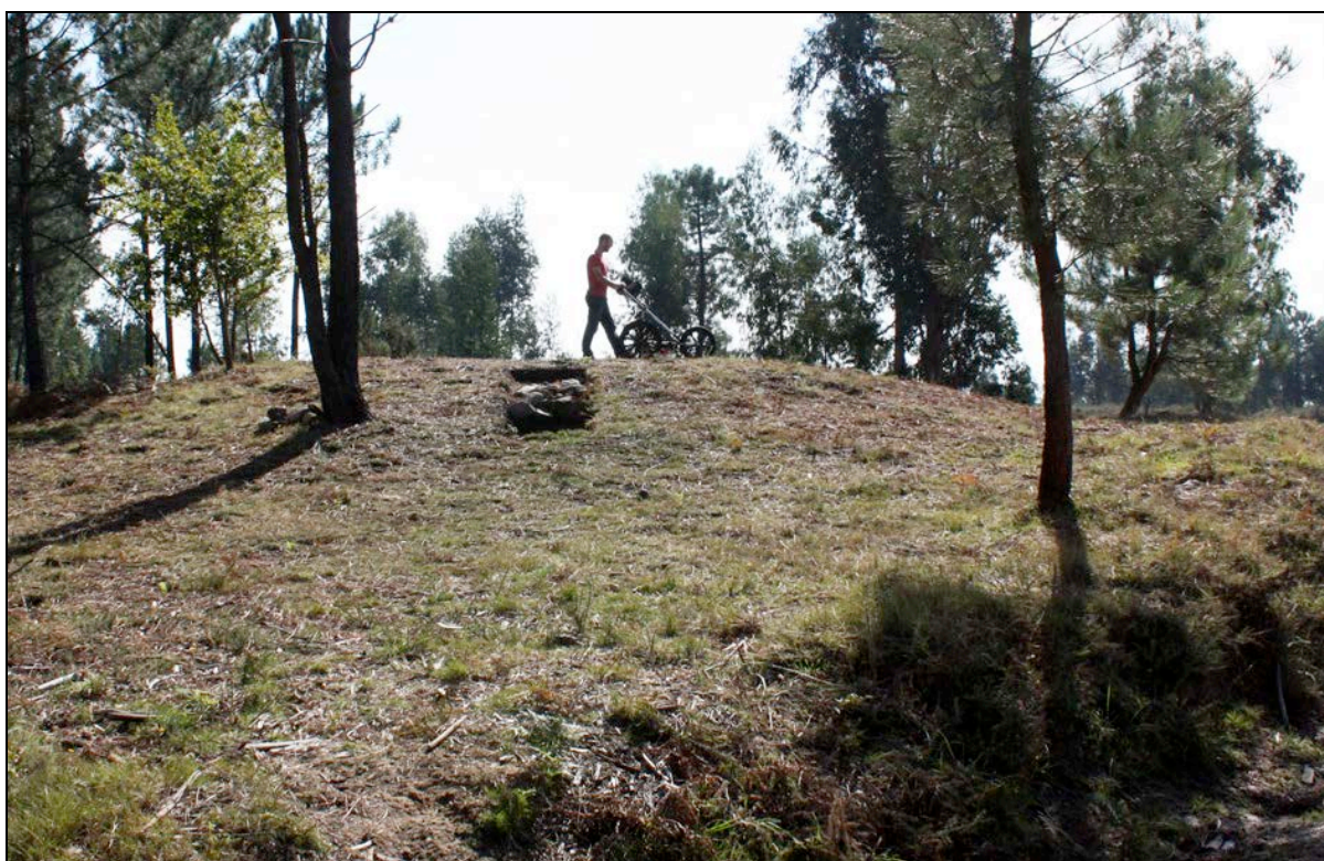
Figura 3.64 – Prospecção preliminar realizada com o a antena de 400 MHz sobre o tumulus da Tojeira. Fotografia da autoria de Rui Barbosa, tirada para sul, observando-se em primeiro plano a sanja norte.
