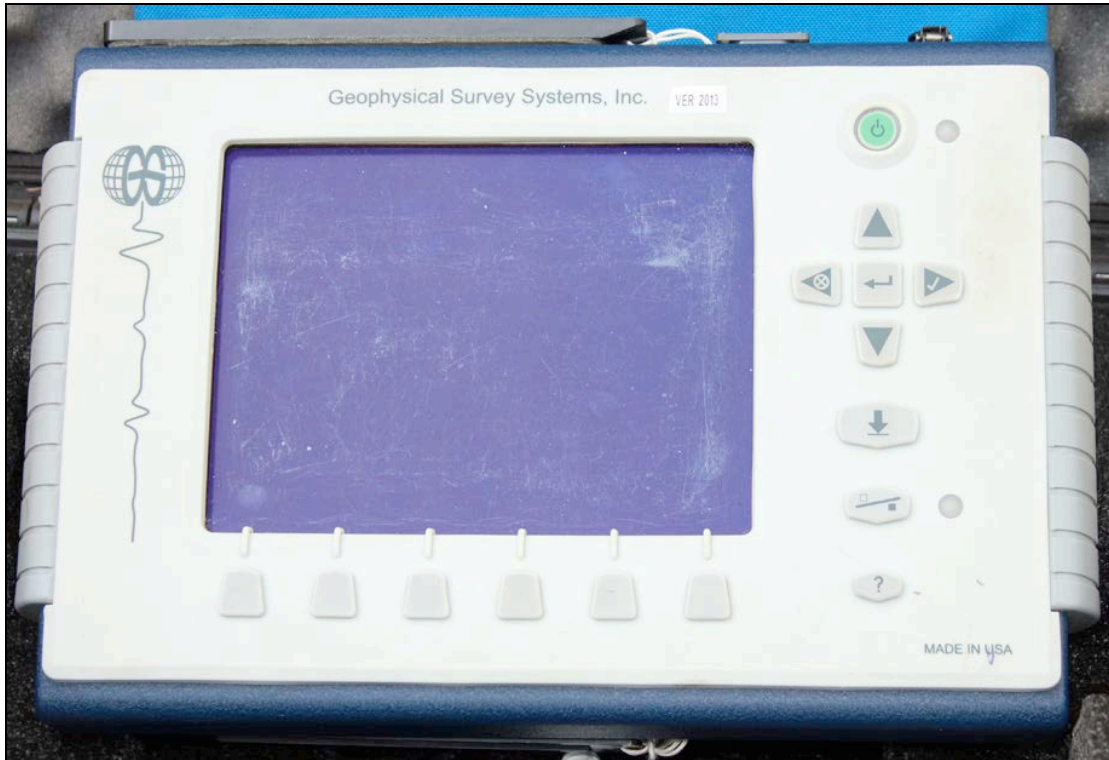
Figura 2.14 – Sir-3000, da GSSI. Este equipamento serve as funções de unidade de controlo electrónico, unidade de armazenamento de dados e unidade de visualização.
