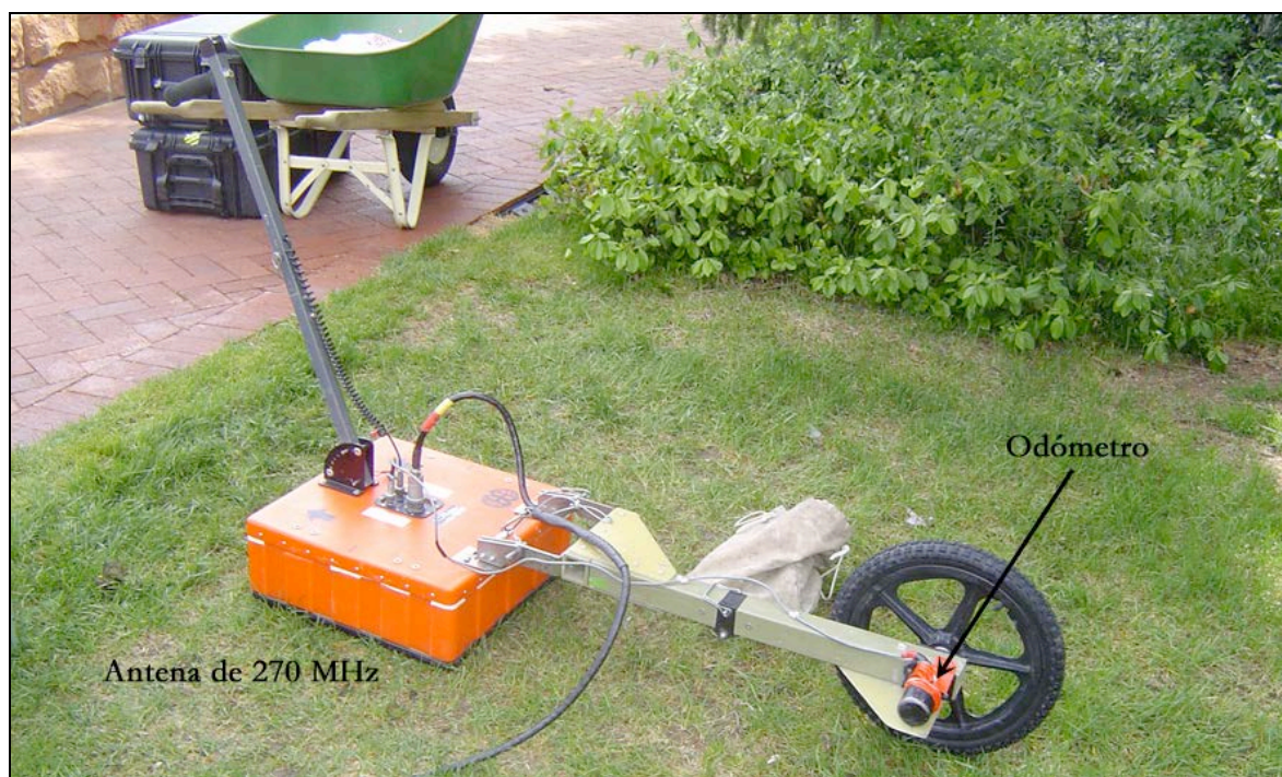
Figura 2.22 – Roda com odómetro ( survey wheel ) associada a antena de 270 MHz da GSSI (o equipamento da imagem é propriedade do professor Lawrence Conyers da Universidade de Denver).
