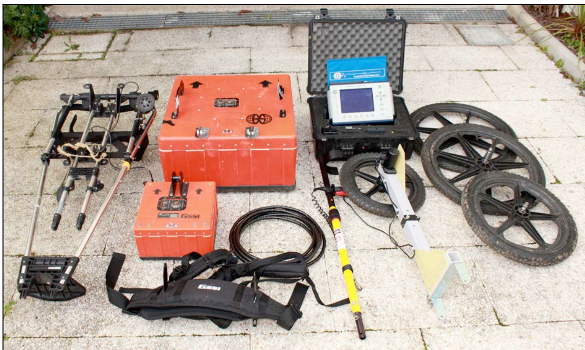
Figura 2.13 – Equipamento de Georadar utilizado nesta dissertação, produzido pela GSSI: as antenas de 200 MHz e 400 MHz; SIR-3000; survey wheel com odômetro; cart com odômetro; cabos de ligação.
