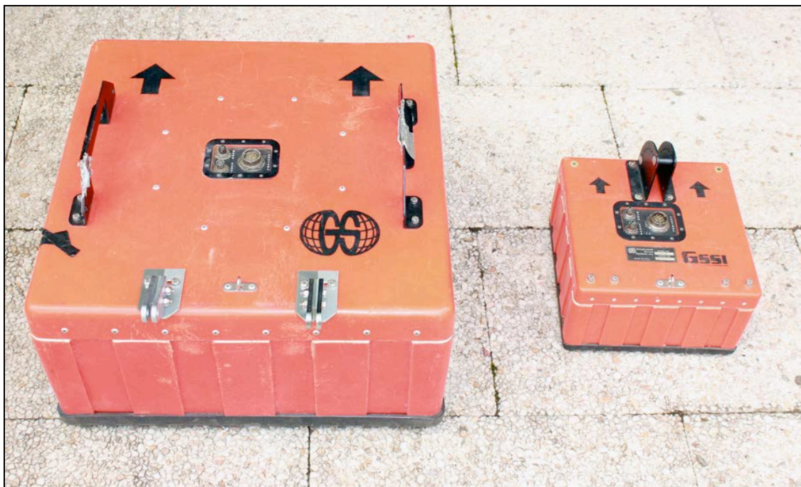
Figura 2.15 – Antenas de 200 MHz (esquerda) e 400 MHz (direita) da GSSI.
