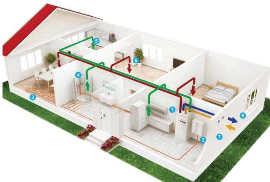
**Figura 59** – Esquema de princípio do sistema de ventilação (Fonte: Nilan, 2012)
