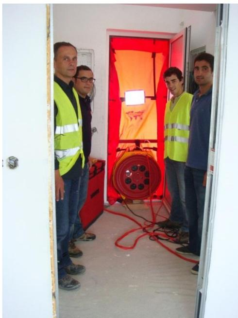
**Figura 63** – A Homegrid e a equipa do ITeCons na realização do Blower Door Test (Fonte: Homegrid, 2012)
