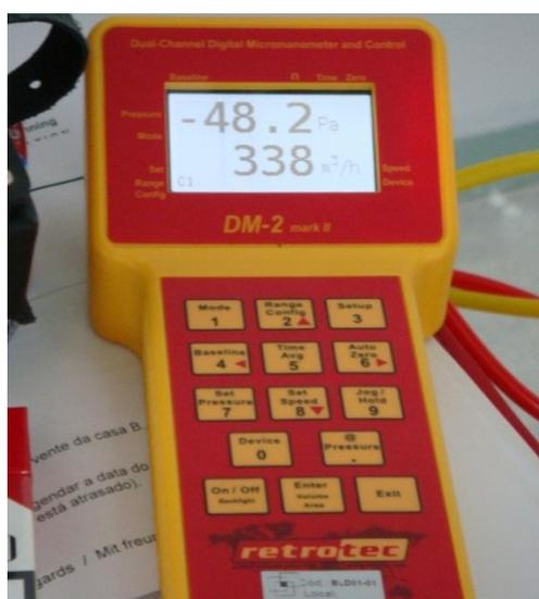
**Figura 64** – Resultado instantâneo do Blower Door Test (Fonte: Homegrid, 2012)
