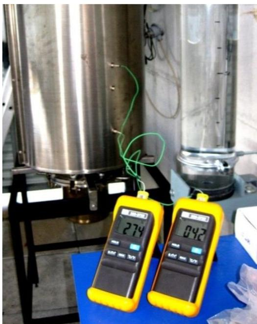
**Figura 76.** Fotografia que ilustra a posição dos termopares, por cima e por baixo da grelha que segura o resíduo durante o processo, cobrindo a zona de reação.
