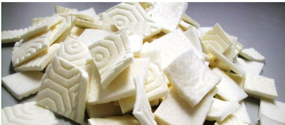
**Figura 80.** Fotografia do resíduo com PVC branco à superfície utilizado nos ensaios de descloração.
