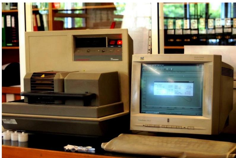
**Figura 23.** Fotografia do equipamento utilizado para os ensaios de comportamento térmico, DTA/TGA 2960 TA Instruments.
