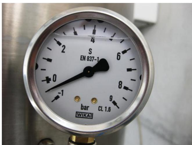
**Figura 77.** Fotografia do manómetro de pressão analógico situado no reator de forma a controlar as reações ou ausência delas, no seu interior.
