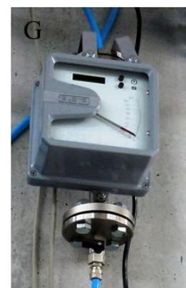
**Figura 79.** Fotografia a 360 ° da instalação piloto. A – Medidor de pressão no interior do reator, B – Medidor de pressão nas colunas, C – Medidor de pH no interior da coluna, D – Recetores de sinal dos medidores de pH, E – Caudalimetro da coluna de limpeza do gás de síntese, F – Controlador de dados e G – Caudalimetro da primeira coluna de fixação.
