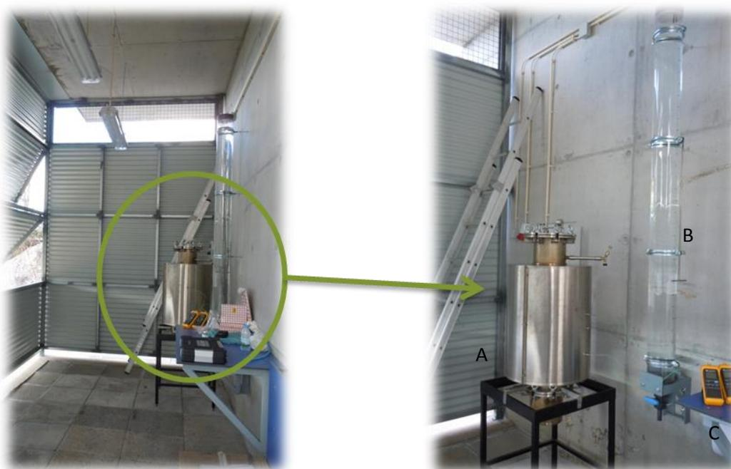
**Figura 66.** Fotografias do interior do anexo onde é possível visualizar o reator (A), a coluna de fixação de gás (B) e os leitores de temperatura (C), instalados.
