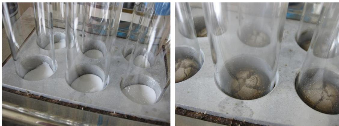
**Figura 43.** Fotografia do PVC puro antes do ensaio e aquando do início da descloração.
