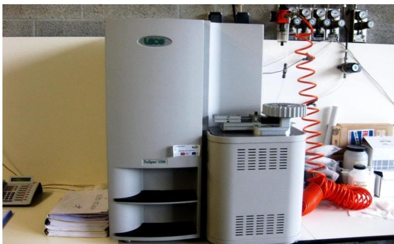
**Figura 25.** Fotografia do equipamento utilizado para a realização das análises elementares, TruSpec CHN da LECO.
