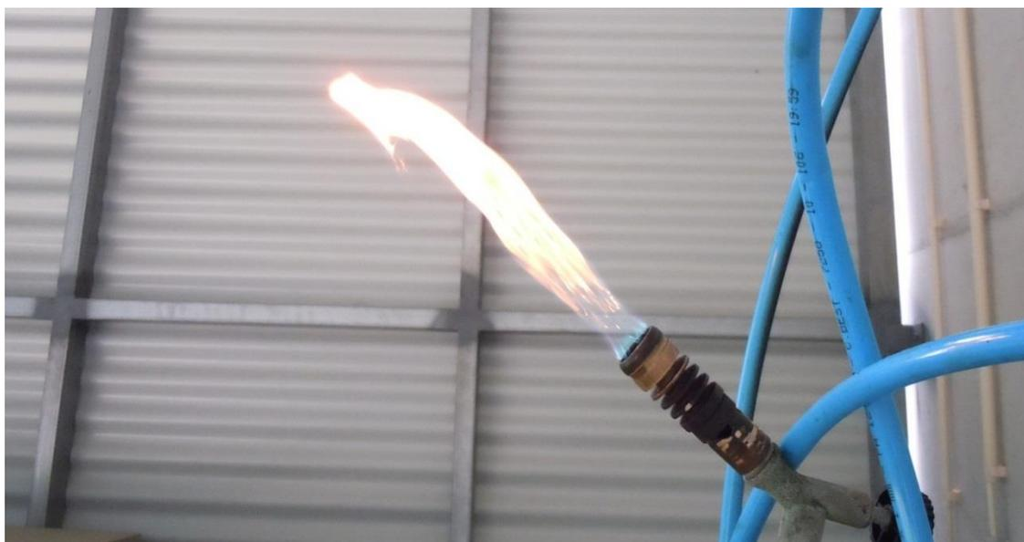
**Figura 90.** Pormenor da queima do gás de síntese produzido nos ensaios da segunda fase, resultante do resíduo rico em carbono e isento de cloro.
