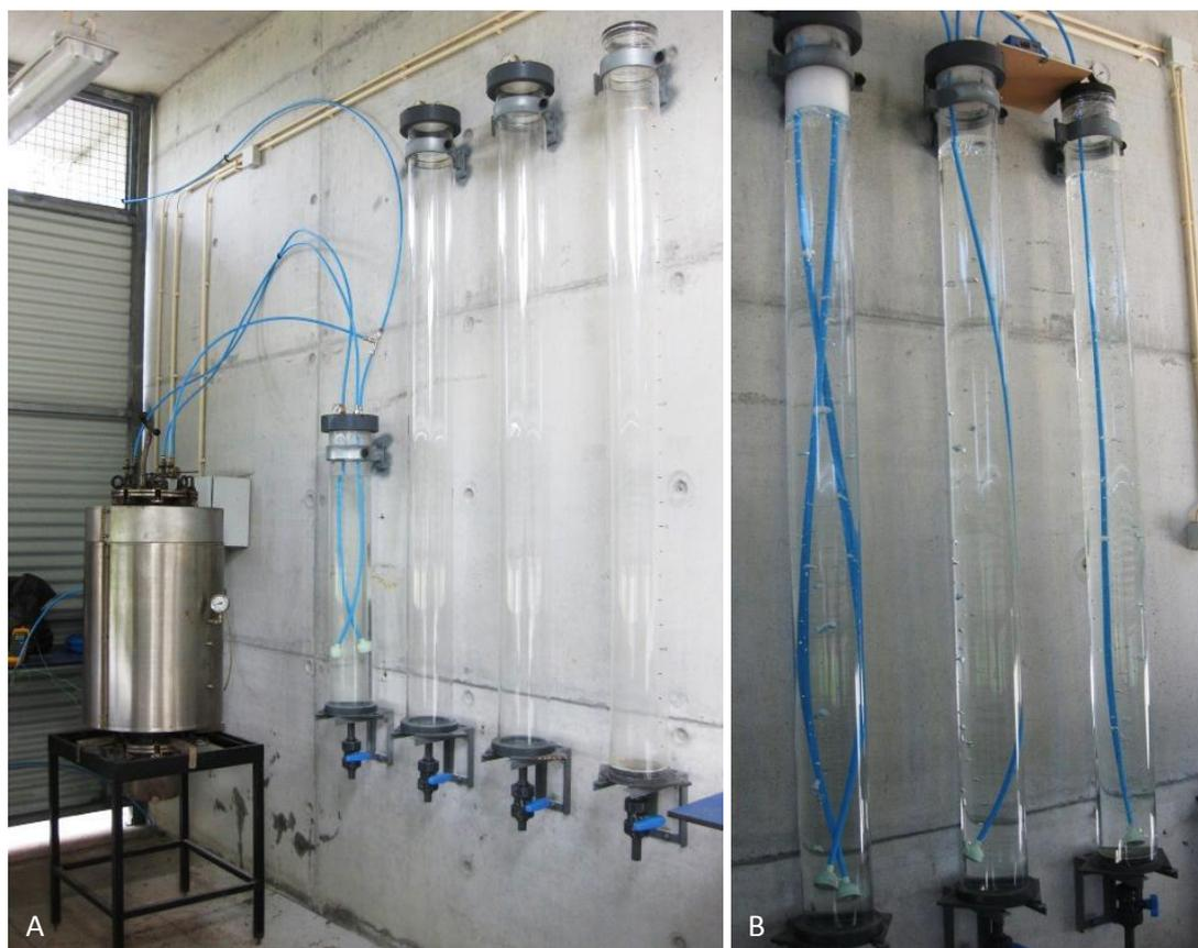
**Figura 72.** Fotografia das quatro colunas em acrílico existentes na instalação: três grandes para fixação do cloro libertado durante o processo de descloração e uma pequena para limpeza do gás de síntese produzido na fase de valorização. A – instalação parada e B – colunas de fixação durante o ensaio de pirólise, onde é nítido o borbulhar do gás.
