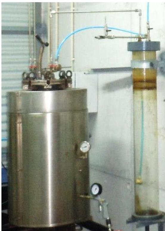
**Figura 89.** Fotografia da coluna de limpeza do gás de síntese produzido durante a segunda fase do processo.
