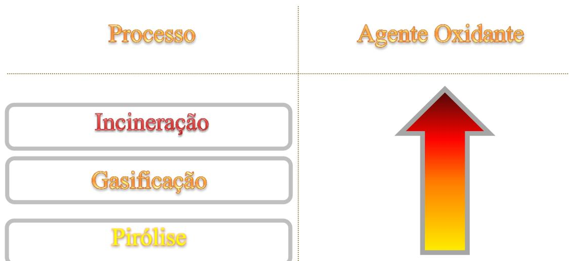
**Figura 15.** Tipologia do processo de valorização energética em função da presença de agente oxidante, desde a sua ausência no processo de pirólise, ao seu excesso no processo de incineração.
