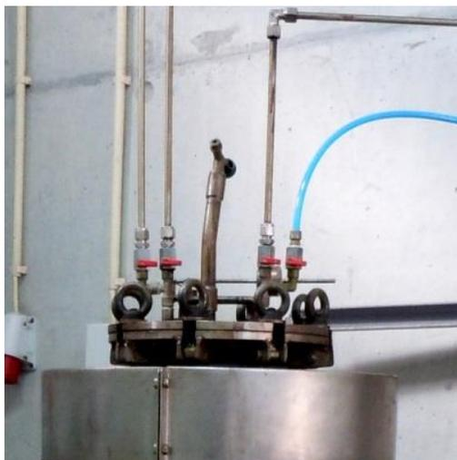
**Figura 69.** Picagens na parte superior do reator e correspondentes tubagens em inox.
