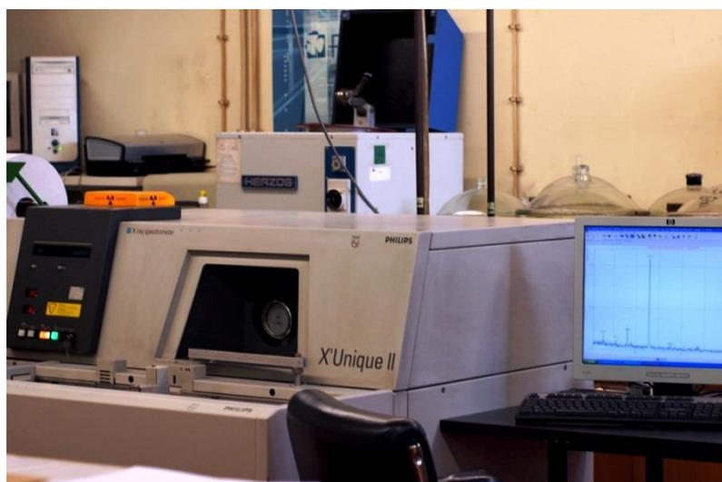
**Figura 24.** Fotografia do equipamento utilizado para a realização das análises de composição química, espectrômetro de fluorescência de raios X (FRX) da Philips, de modelo X'Unique II.
