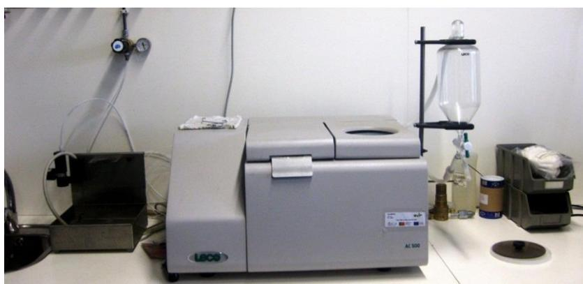
**Figura 26.** Fotografia do calorímetro utilizado para as análises de PCI, AC500 da Leco.
