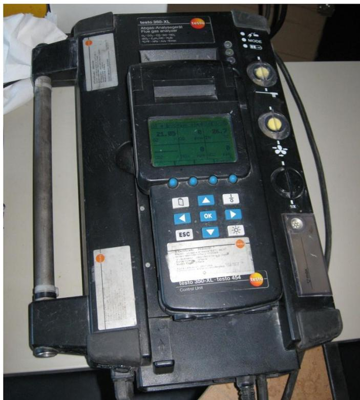
**Figura 28.** Fotografia do analisador de gases utilizado nos ensaios em escala laboratorial, 350XL da Testo.
