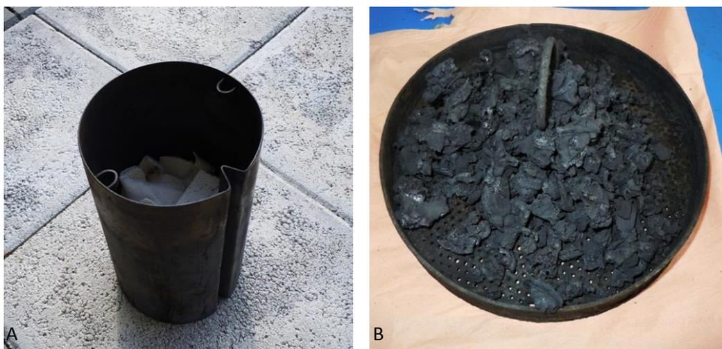
**Figura 78.** Fotografias: A – recipiente utilizado como suporte do resíduo na fase de pirólise e B – grelha com resíduo carbonoso resultante da pirólise para ser submetido a valorização energética.
