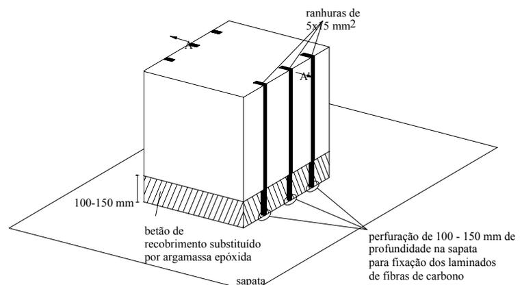
Figura 16 – Reforço dos elementos de pilar.
