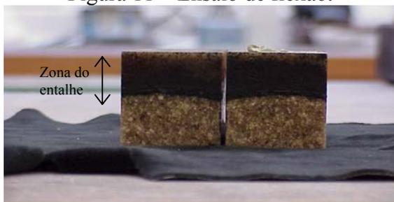
Figura 13 – Aspecto final do provete ensaiado
