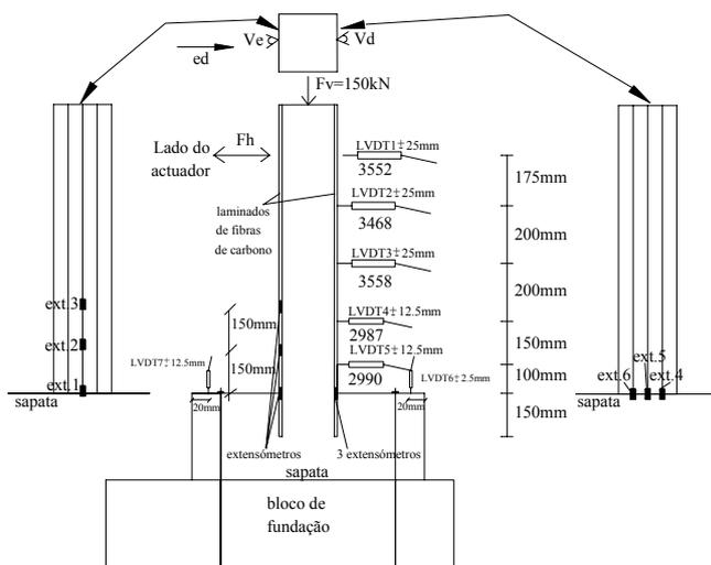
Figura 5 – Transdutores de deslocamentos e extensômetros aplicados.
