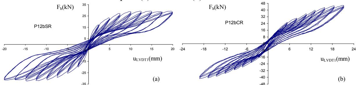
Figura 23 – Relação entre a força horizontal e o deslocamento de controlo nos elementos de pilar (a) *P12bSR* e (b) *P12bCR*.
