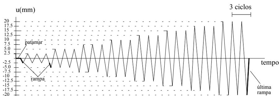
Figura 7 – Ciclos de carga aplicados nos ensaios.
