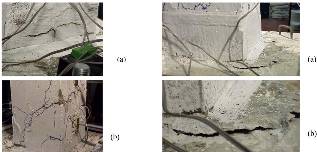
Figura 29 – Deficiências no reforço do pilar P16aCR. Figura 30 – Deficiências no reforço do pilar P16bCR.
