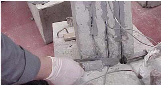
Figura 20 - Fixação dos laminados a um elemento de pilar.
