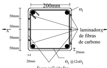
Figura 15 – Secção transversal dos elementos de pilar.
