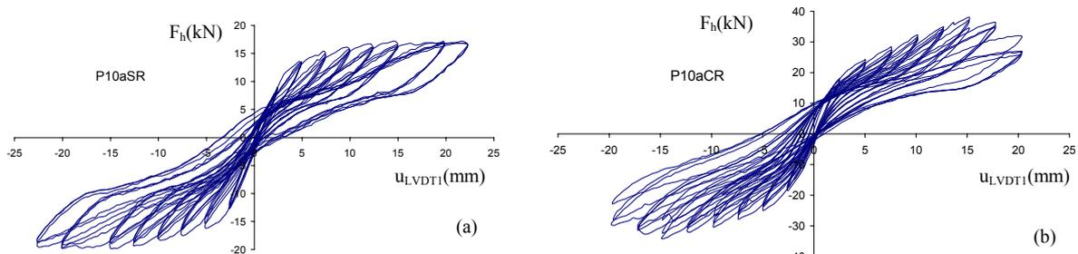
Figura 22 – Relação entre a força horizontal e o deslocamento de controlo nos elementos de pilar (a) *P10aSR* e (b) *P10aCR*.
