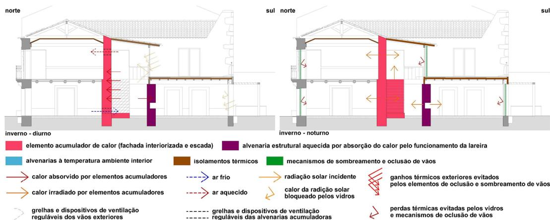
Fig. 6.16 Esquemas de funcionamento da estufa solar a implementar no caso de estudo, sintetizando o seu funcionamento durante os meses frios em período diurno e noturno (ver Anexo 3, Fig A3.3)
