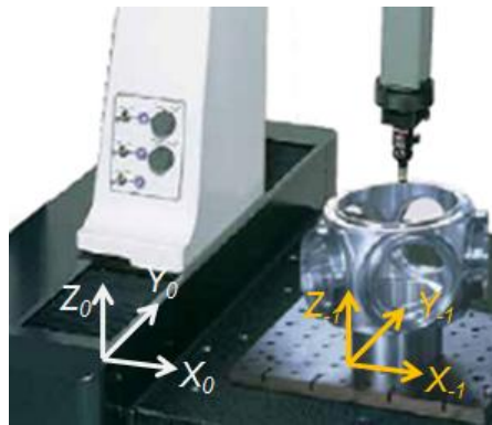
Fig. 23 Introdução do referencial do objeto (Renishaw, 2011)
