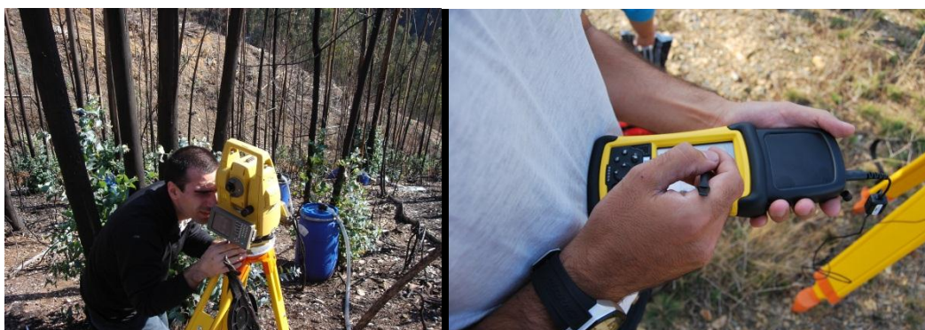
Fotografia 6. Levantamento topográfico de pormenor efetuado nas áreas de estudo
