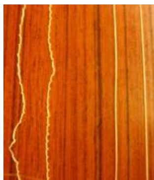
Figura 5.27 - Linhas de costura após (esquerdo) e antes (direito) o processo de costura
