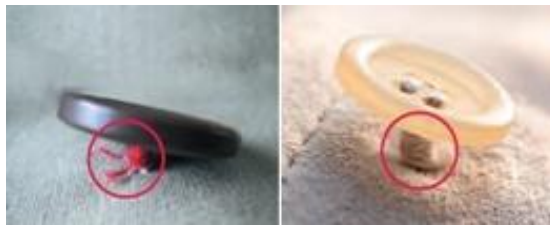
Figura 2.7 - Botão costurado com linha convencional e com a Ascolite TF [14]
