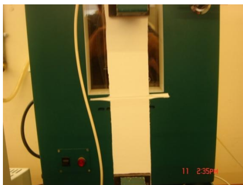
Figura 4.3 - Proвете para ensaio da resistência à tração da costura no dinamómetro
