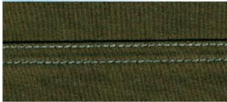
Figura 2.20 - Linhas de costura PA num processo de tingimento em peça de algodão [18]
