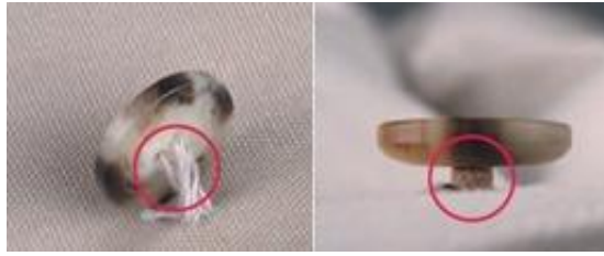
Figura 2.6 - Botão costurado com linha convencional e com a Ascolite TF [14]
