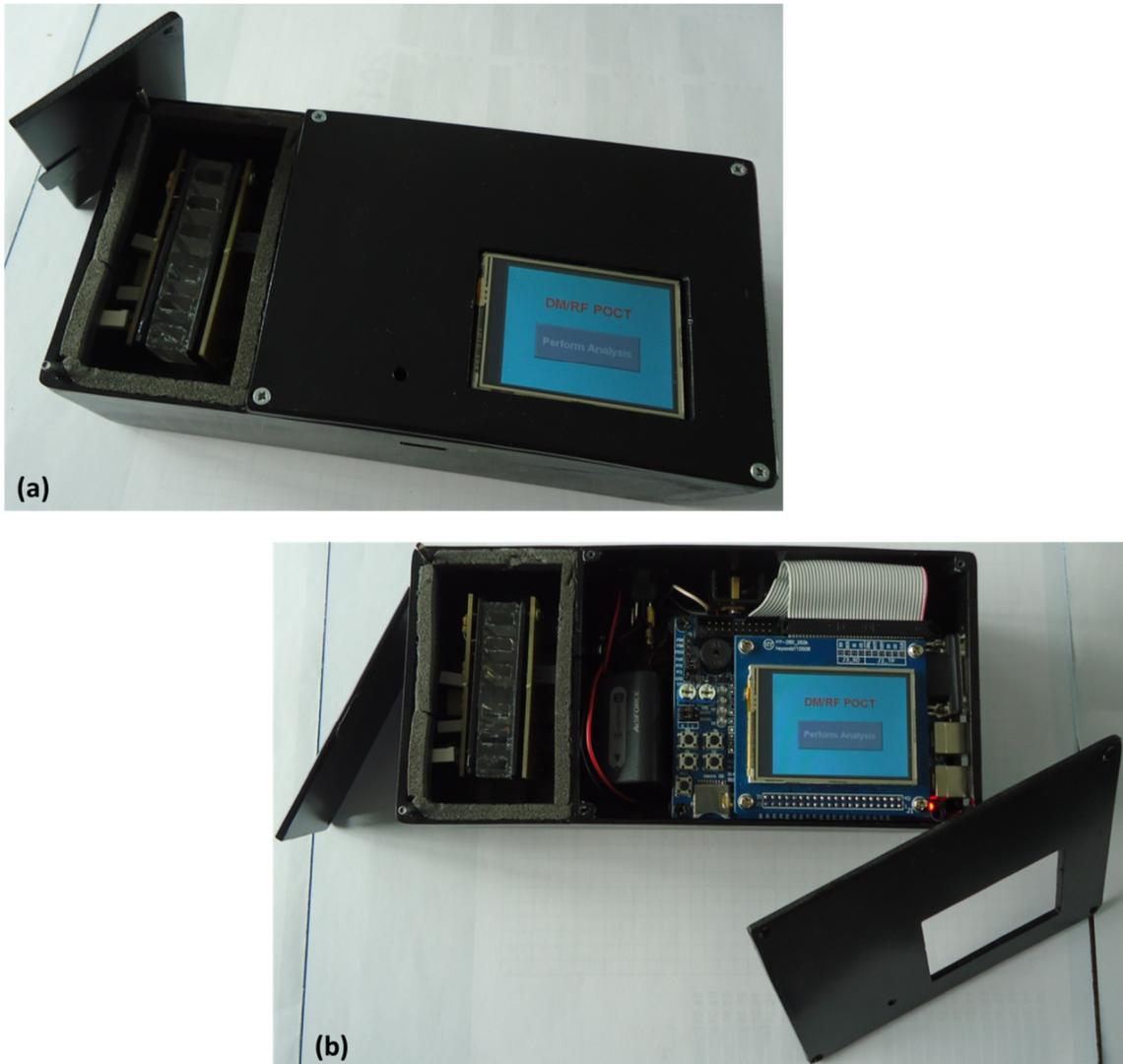
**Figura 6.7 - (a)** Visão do compartimento de análise; **(b)** Visão do compartimento de análise e de comando.
