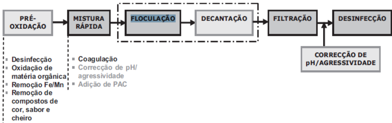
Figura 2: Esquema-tipo de tratamento de água de origem superficial em Portugal
