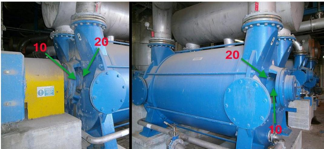
**Figura 147** – Localização dos pontos de inspeção do PT-15-3GB -0080
