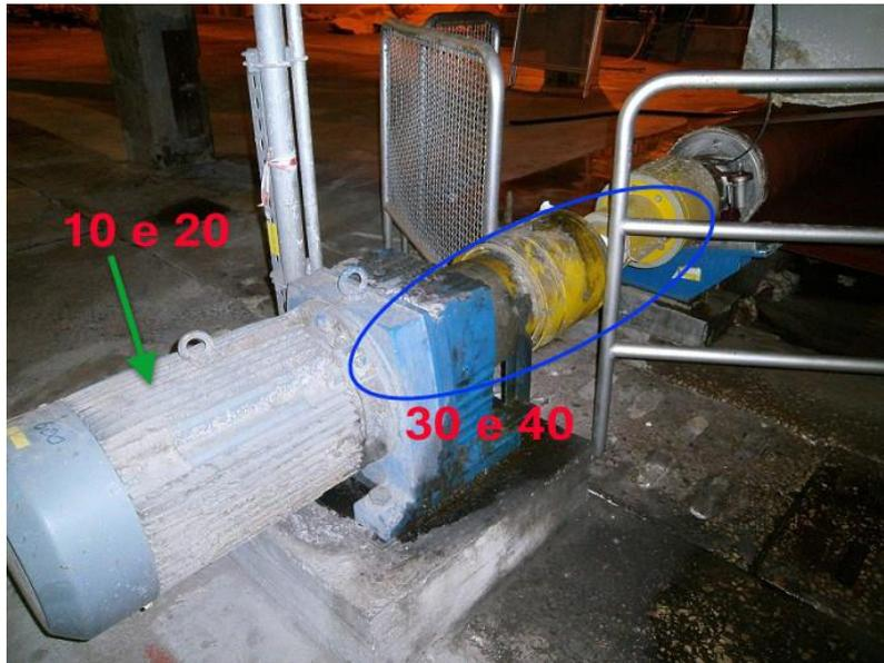
**Figura 157** – Localização dos pontos de inspeção do PT-15-4101-0002
