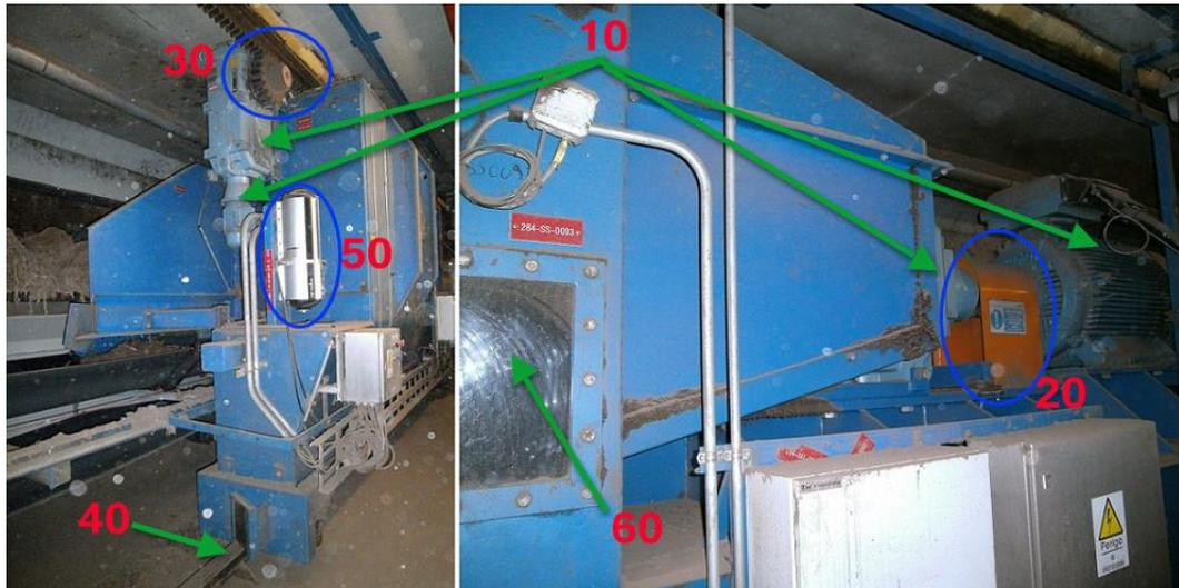
**Figura 137** – Localização dos pontos de inspeção do PT-15-3GSF-0020
