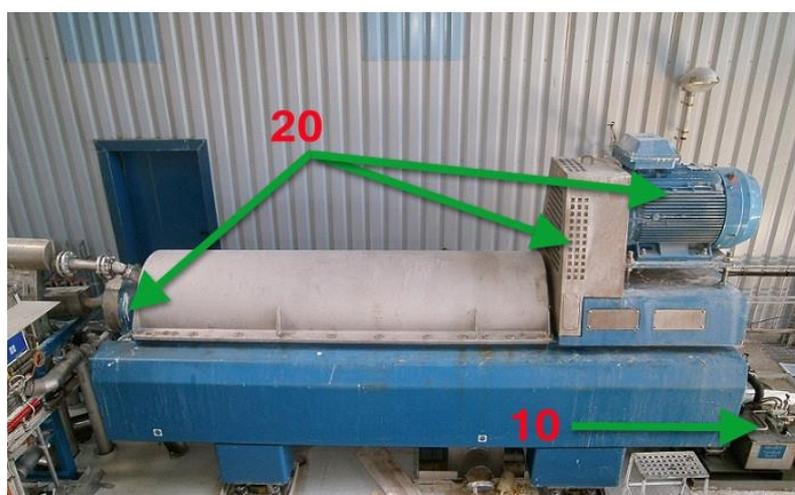
**Figura 55** – Localização dos pontos de inspeção do PT-15-3GDC-0003
