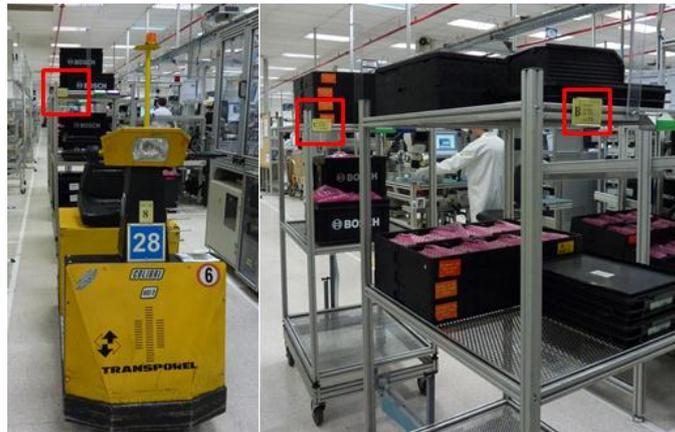
Figura 36 – Processo de identificação dos pontos de abastecimento.
