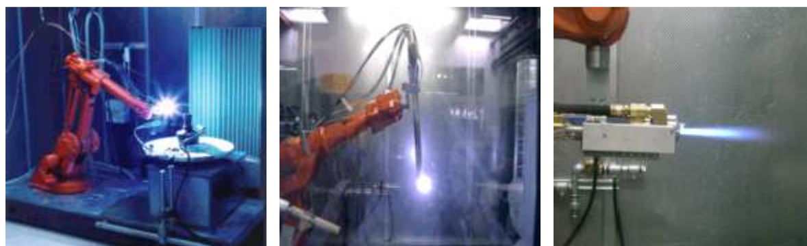
Figura 1.5: Imagens do sistema de projecção plasma utilizado para a produção dos revestimentos estudados neste trabalho [65].
