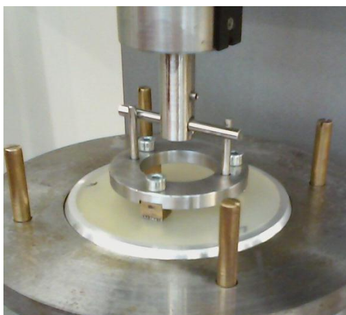
Figura 38 - Componentes alterados já montados no equipamento FRICTORQ®
