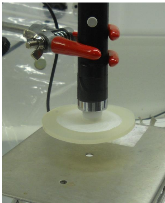
Figura 56 – Borracha de silicone adere à cabeça da sonda devido ao vâcuo
