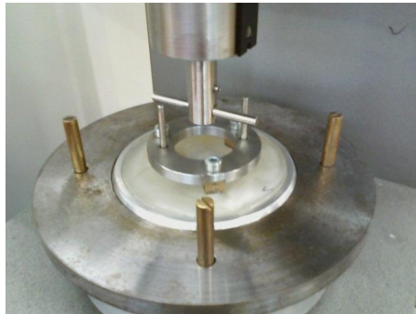
Figura 40 - FRICTORQ preparado para iniciar um teste de atrito
