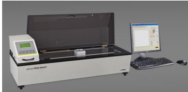
Figura 14 - Tribómetro PARAM FPT-F1 [12]
