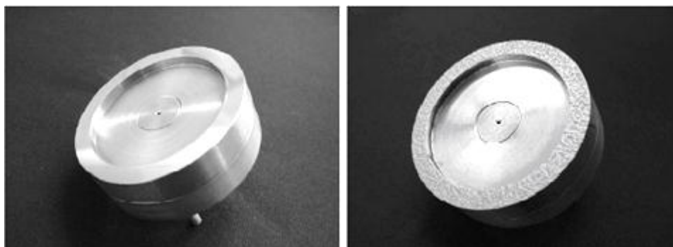
Figura 29 - Corpo de prova anelar com superfície lisa e tratada quimicamente
