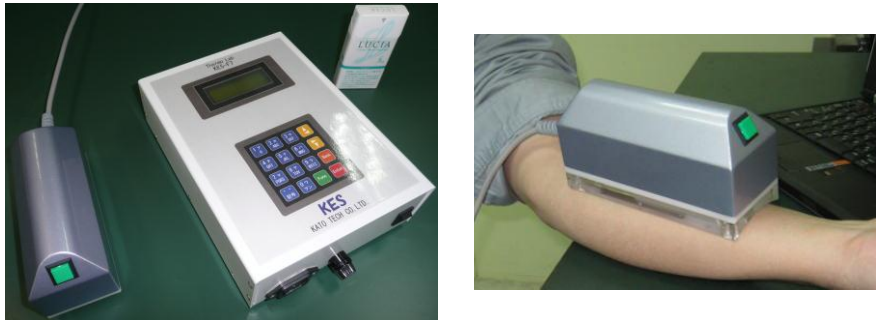
Figura 21 - Equipamento de medição de atrito portátil da KES [7]
