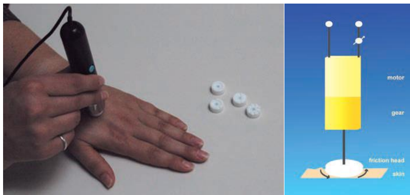
Figura 22 - Sonda Frictiometer e esquema representativo [22]
