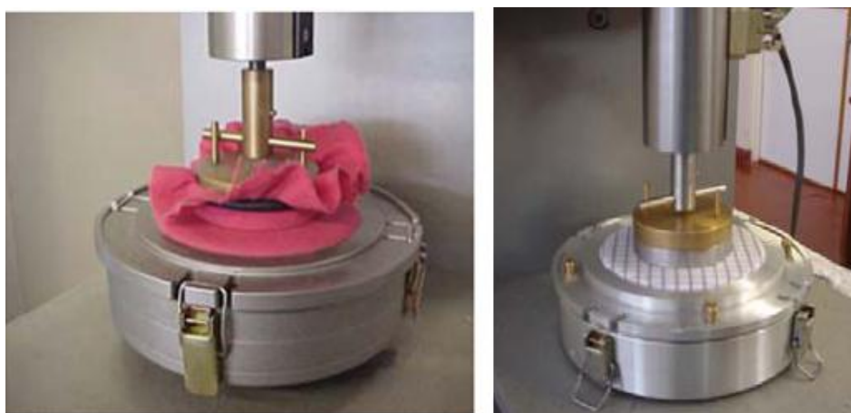
Figura 30 - Ensaios na modalidade tecido-tecido (esquerda) e tecido-metal (direita)
