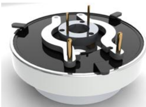
Figura 33 - Modelação 3D da base de ensaios para análise de peles artificiais
