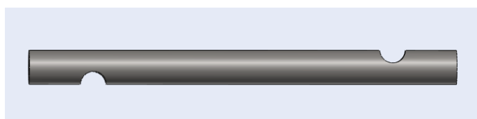
Figura 36 - Barra de acoplamento do sensor com entalhes
