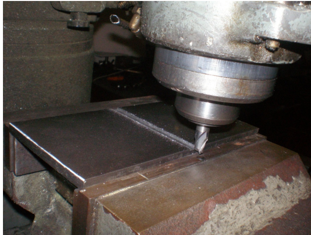
Figura 3. 30 - Execução do rasgo no provete.
