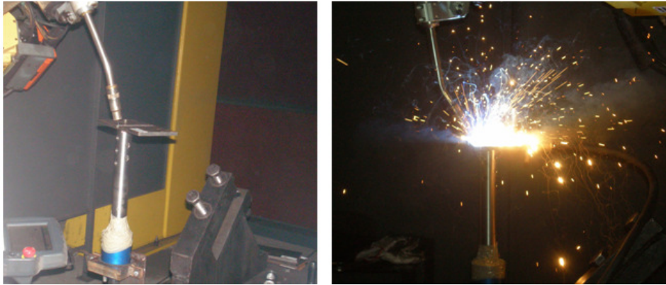
Figura 3. 47 - Soldadura com os ultrassons activos.
