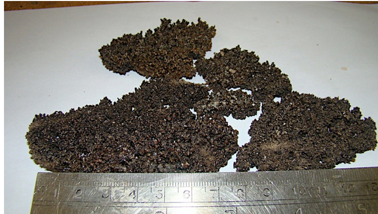
Figura 1.2 - Cinzas fundidas e agregadas formadas na instalação experimental
