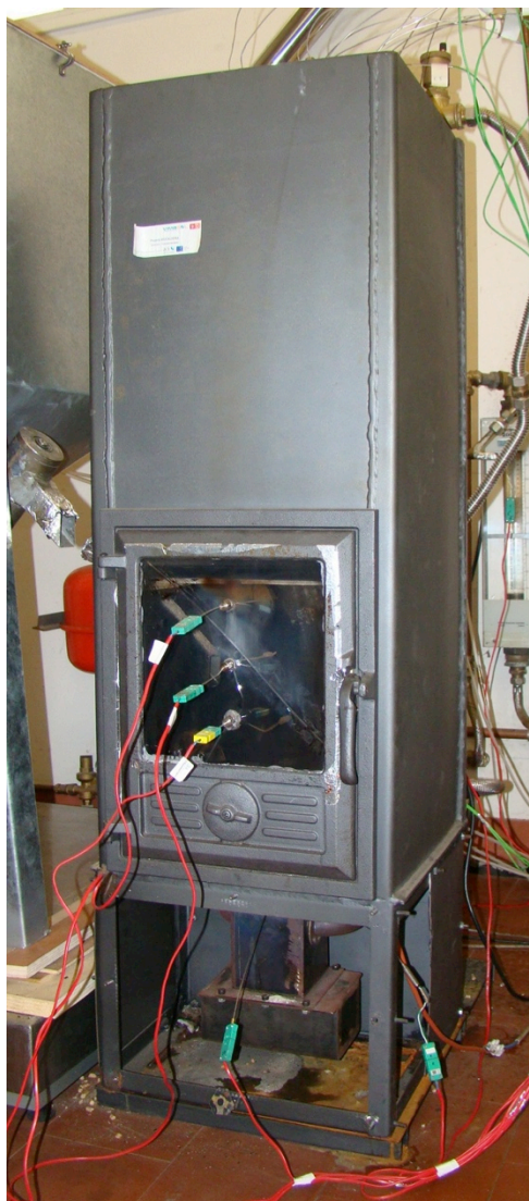
Figura 3.2 - Caldeira a pellets utilizada na instalação
