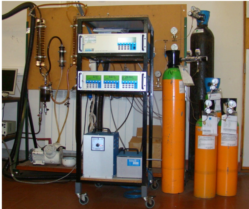
Figura 4.16 - Sistema de recolha e análise de gases na instalação.
