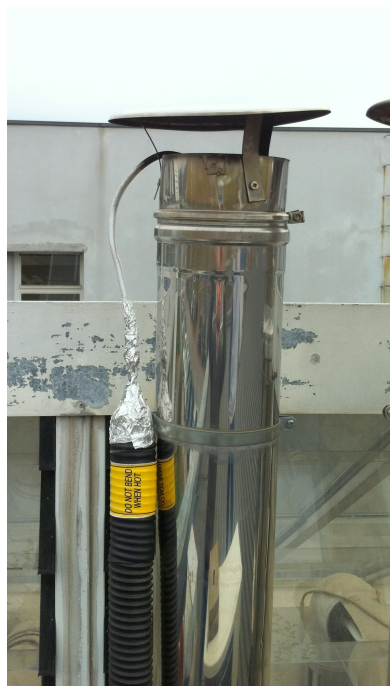
Figura 4.17 - Sonda de captação de gases para análise de \text{NO}_x .
