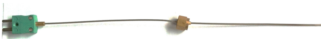
Figura 4.10 - Termopar K de bainha metálica com bicone de vedação
