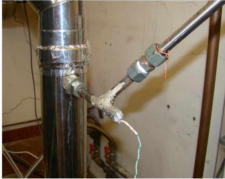
Figura 4.14 - Sonda de captação de gases elementares CO, CO 2 e O 2
