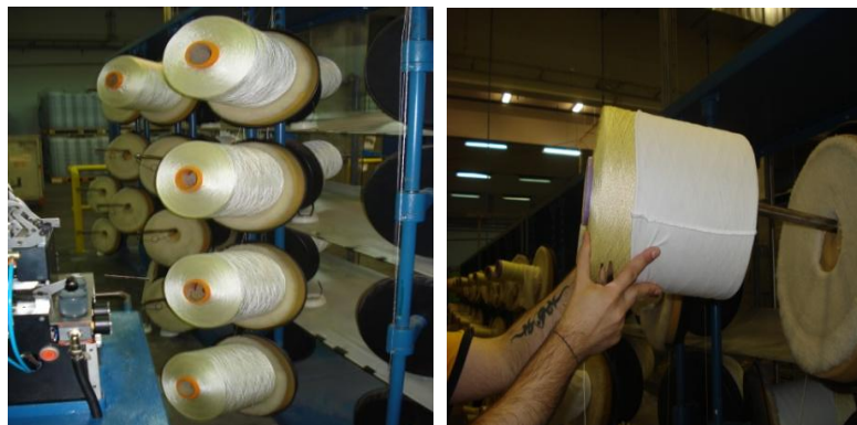
Figura 4.18 – Carregamento da esquinadeira da Single End
