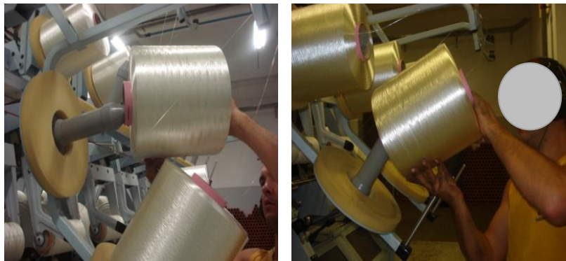
Figura 4.15 – Carregamento do carro esquinadeira posição inferior e superior
