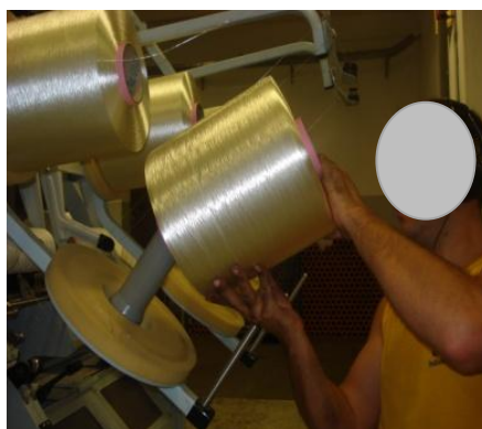
Figura 4.7 – Carregamento da esquinadeira na posição inferior
