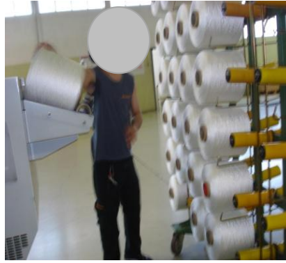
Figura 4.10 – Descarregamento do torcedor
