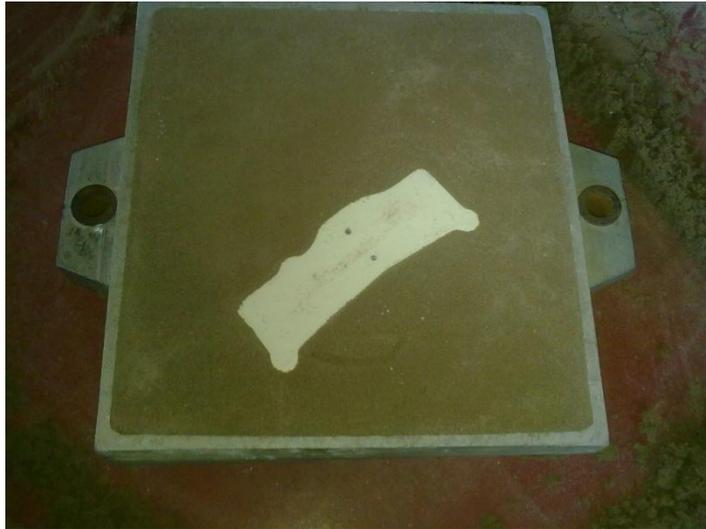
**Figura B 19.**Meia moldação inferior já com areia calcada
