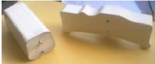
**Figura 3-11-Moldes de madeira superior e inferior**
