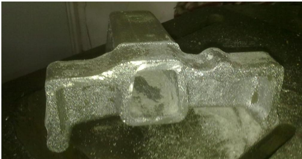
**Figura B 18-Coletor com rebarbagem parcial**
