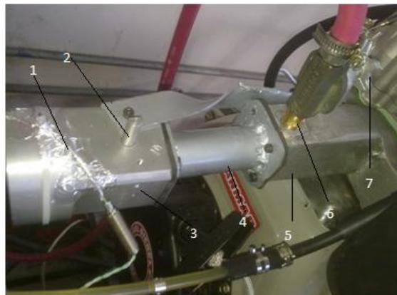
**Figura 3-14-Conjunto do colector-5,termopar-1, borboleta-2,3-suporte borboleta, ligação colector-suporte borboleta-4 injetor de gás-6 e válvula, abertura-7**
