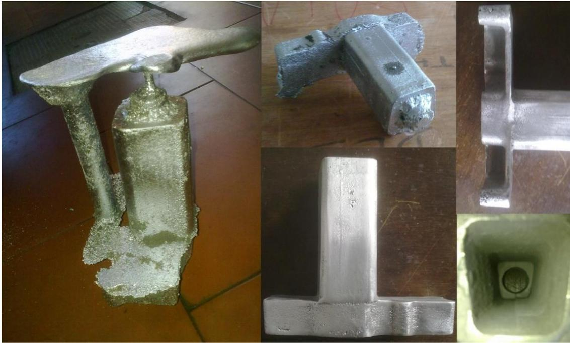
**Figura 3-13-Peça fundida com vários estágios de limpeza**
