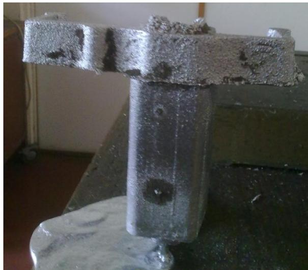
**Figura B 17-Coletor sem rebarbagem**
