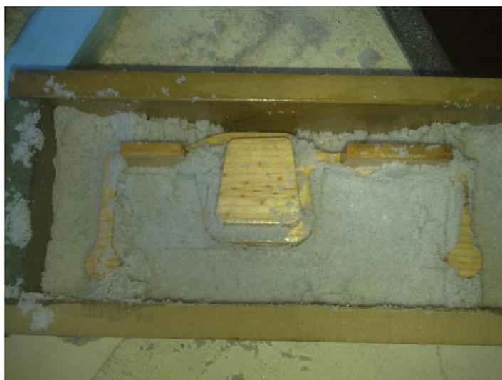
**Figura B 13-Enchimento da areia da moldação superior em areia de Silicato Sodio**
