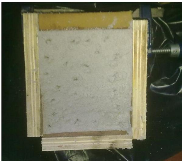
**Figura B 11-Inserção de meia moldação num saco para insuflar CO<sub>2</sub>**
