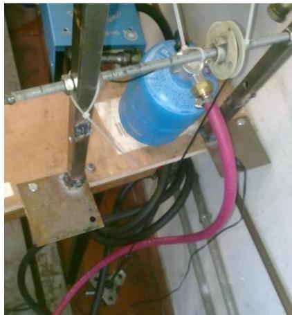
**Figura 3-17.Sistema de roldana para colocar reservatório de gás na balança**
