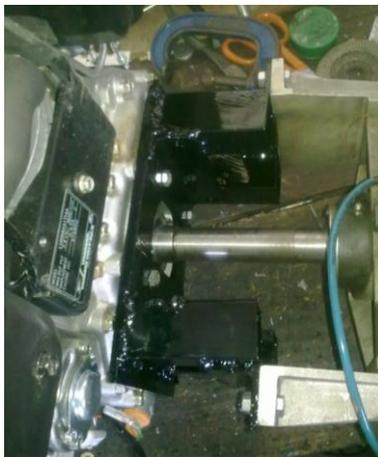
**Figura 3-7-Resultado real da estrutura e dinamómetro com veio de construção**
