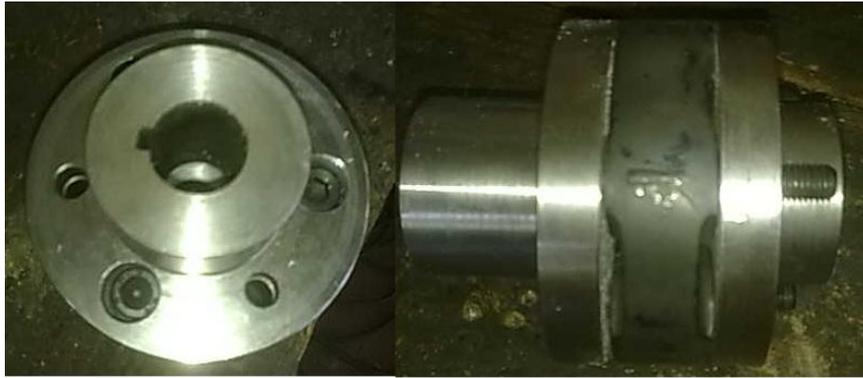
**Figura 3-3-Flanges reais e ligação flexível**
