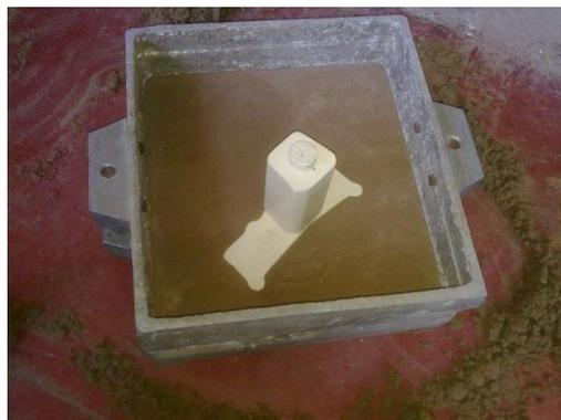
**Figura 3-12-Enchimento das caixas de moldação com areia**
