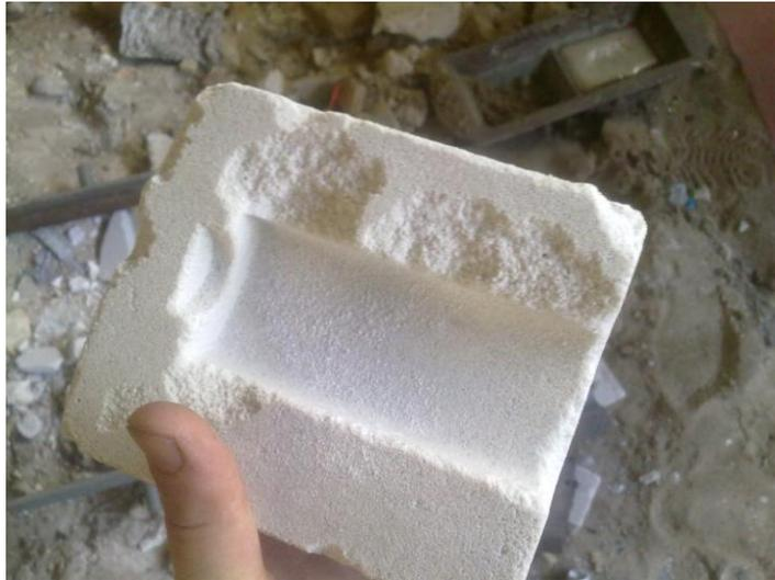
**Figura B 8-Meia moldação em areia de silicato sodio**
