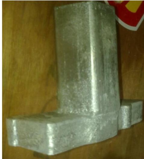
**Figura B 16-Coletor fundido visto de lado**
