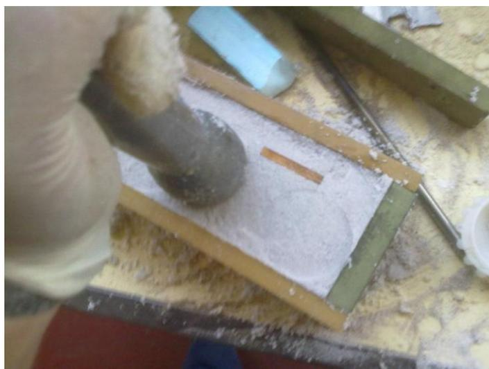
**Figura B 12- Batimento da areia da moldação superior em areia de Silicato Sodio**
