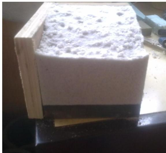
**Figura B 10-Desmoldação de meia moldação**
