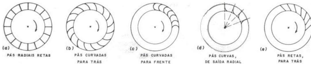
Figura 35 - Ventiladores por tipo de forma de pás [11]
