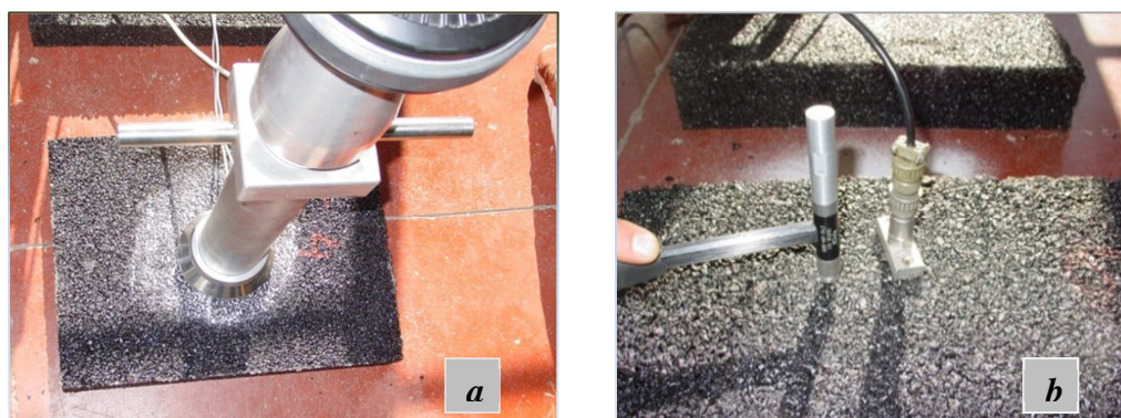
Fig 2. Imagens dos ensaios de: a) absorção acústica com o tubo de impedância, b) impedância mecânica usando um martelo instrumentado e um acelerômetro.
