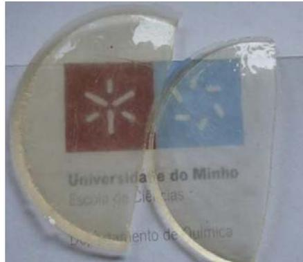
**Figura 48-** SPEs baseados na matriz híbrida d-U(900) com composição é d-U(900)<sub>100</sub> LiSbF<sub>6</sub> (esquerda) e d-U(900)<sub>200</sub> LiAsF<sub>6</sub> (di direita).
