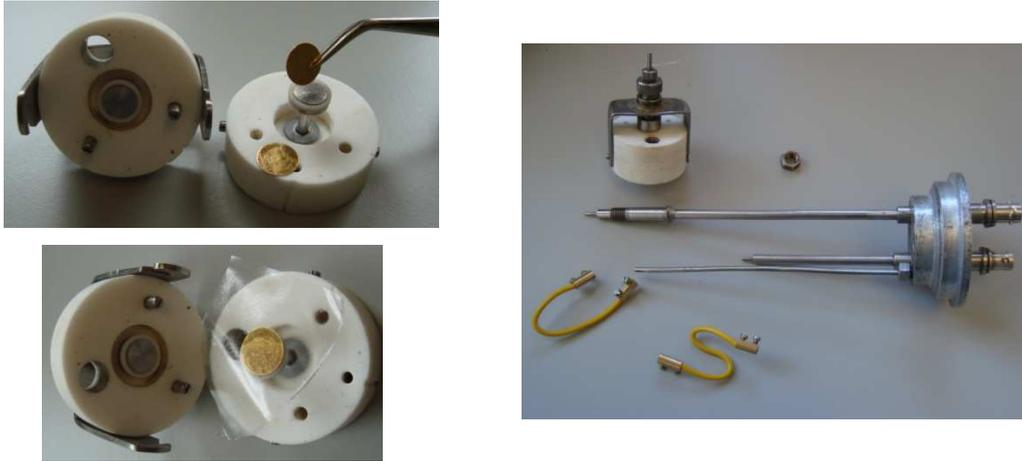
**Figura 21-** Imagens dos componentes utilizados na preparação para a montagem da célula eletroquímica utilizada para medições de condutividade iónica.
