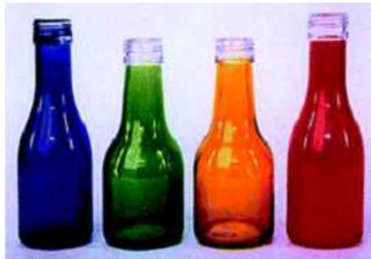
**Figura 5** – Garrafas de recidagem facilitadas pela incorporação de corantes orgânicos, adaptada de ref [25]
