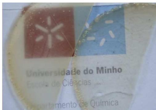
**Figura 40-** SPEs baseados na matriz híbrida d-U(2000) cuja composição é  $\text{d-U(2000)}_8\text{LiSbF}_6$  e  $\text{d-U(2000)}_5\text{LiAsF}_6$ , (da esquerda para a direita).
