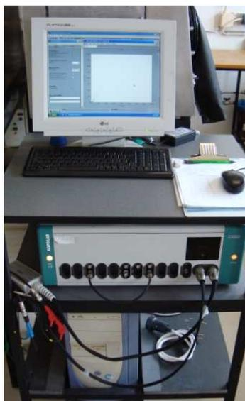
**Figura 24-** Imagem do sistema utilizado na medição de condutividade iónica.
