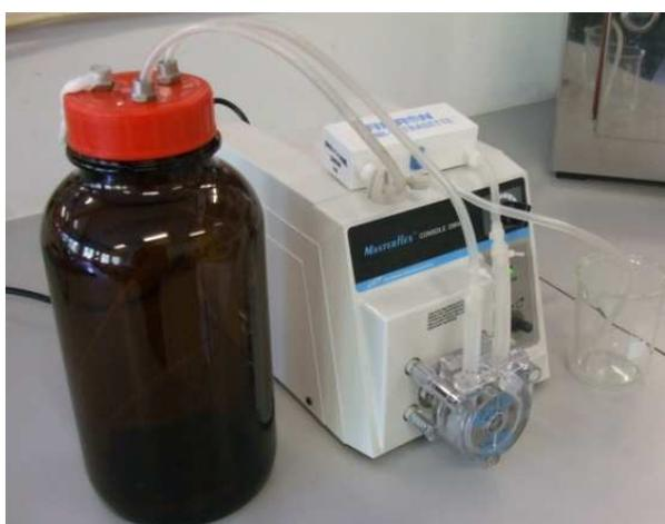
**Figura 12-** Montagem utilizada na purificação da matriz de a-PEO por escoamento tangencial.
