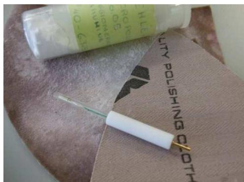
**Figura 26-** Imagem dos componentes de limpeza do microeléctrodo (Camurça, alumina de polimento e microeléctrodo de ouro)
