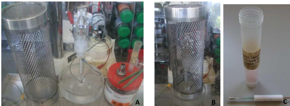
**Figura 25-** Imagens dos componentes utilizados na medição de estabilidade electroquímica.
