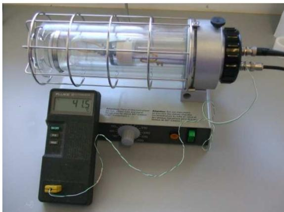
**Figura 23-** Imagem do forno de Buchi TO-51 no qual se efetua a preparação térmica e a medição da condutividade iónica.
