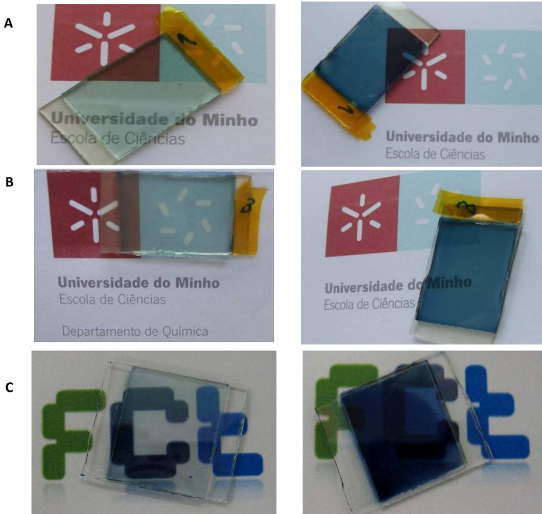
**Figura 78-** Protótipo de janelas inteligentes das amostras de SPEs baseados na matriz híbrida  $d\text{-PCL}(530)$ : A- dopada com  $\text{LiClO}_4$ , B- dopada com  $\text{LiBF}_4$  e C- dopada com  $\text{LiTFSI}$ ; nos estados transparente e colorido (da esquerda para a direita).
