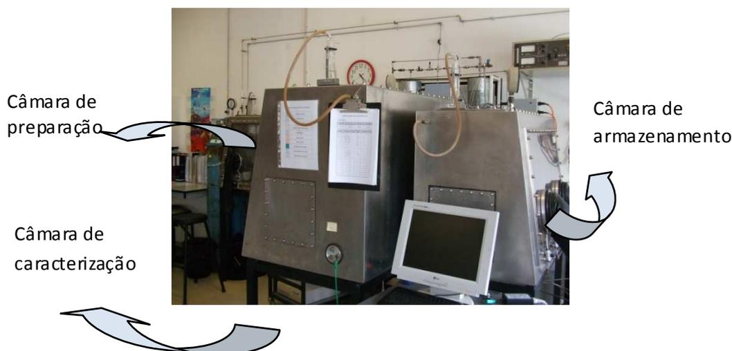
**Figura 2-** Imagem das câmaras de luvas existentes no laboratório de eletrólitos poliméricos da Universidade do Minho.
