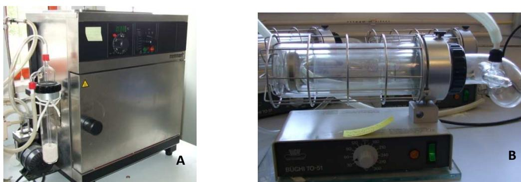
**Figura 5 A-** Estufa com sistema de recirculação; **B-** Fomo de Buchi TO-51.
