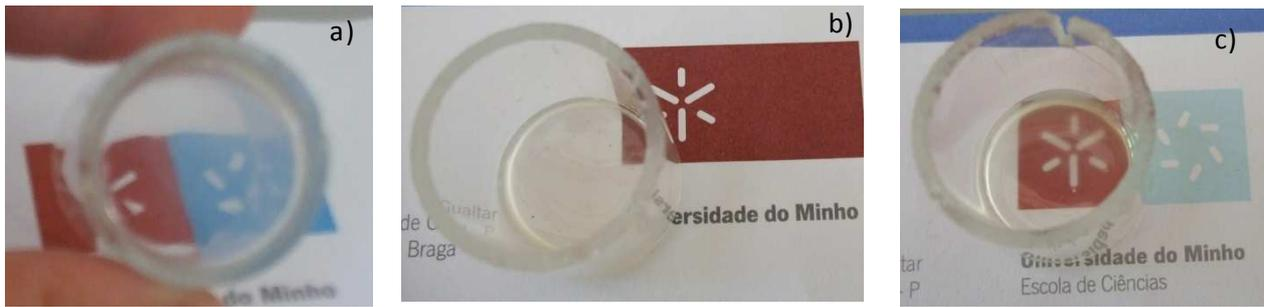
**Figura 12-** SPE dos sistemas a- $\text{PEO}_n\text{LiX}$ : a)  $n=8$  e  $\text{X}^- = \text{ClO}_4^-$ ; b)  $n=12$  e  $\text{X}^- = \text{BF}_4^-$ ; c)  $n=15$  e  $\text{X}^- = \text{SbF}_6^-$ .
