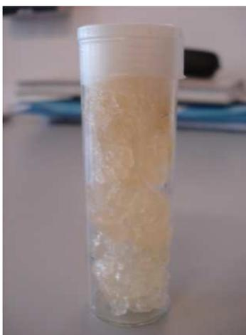
**Figura 11-** Polímero a-PEO obtido após purificação com tolueno e hexano.
