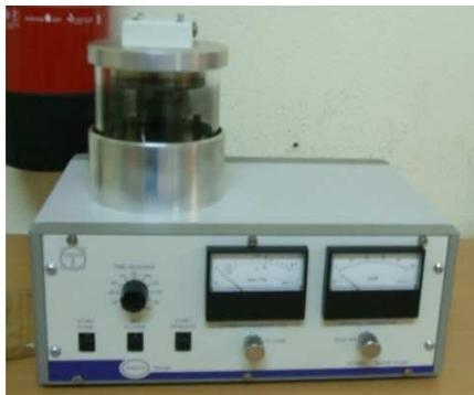
**Figura 37-** Imagens do equipamento Depositador de Ouro/Paládio (Polaron Range SC7620 Sputter Coater), da UTAD.
