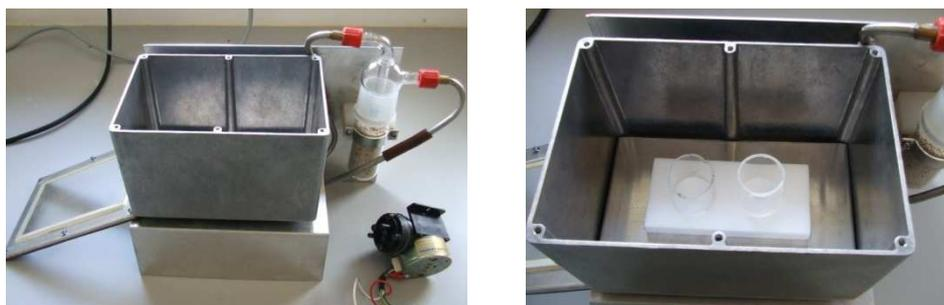
**Figura 4** – caixa de recirculação onde permanecem os SPE para secagem.
