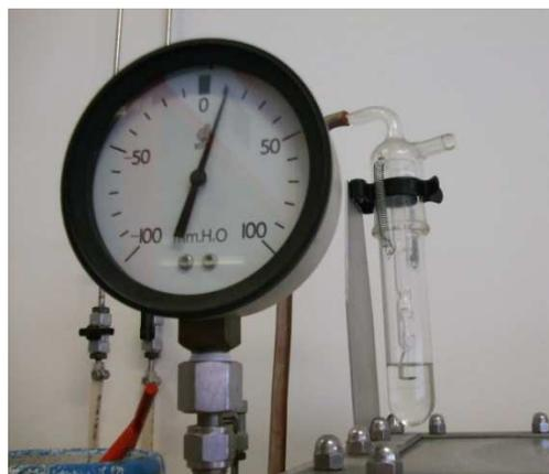
**Figura 3-** Manómetro e borbulhador controlador de pressão.
