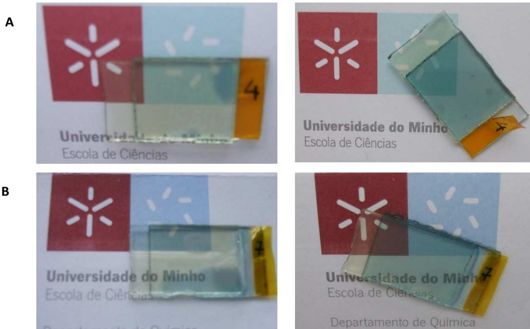
**Figura 64-** Protótipo de janelas inteligentes das amostras de SPEs  $d-U(600)_nLiXF_6$ : A-  $n=20$   $X=As$ , B-  $n=15$   $X=Sb$  nos estados transparente e colorido (da esquerda para a direita).
