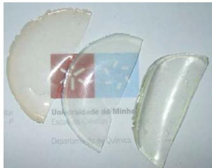
**Figura 70-** SPEs baseados na matriz híbrida d-PCL(530) cuja composição é  $\text{d-PCL(530)}_{15} \text{LiClO}_4$ ,  $\text{d-PCL(530)}_{20} \text{LiBF}_4$  e  $\text{d-PCL(530)}_{40} \text{LiTFSI}$ , (da esquerda para a direita).
