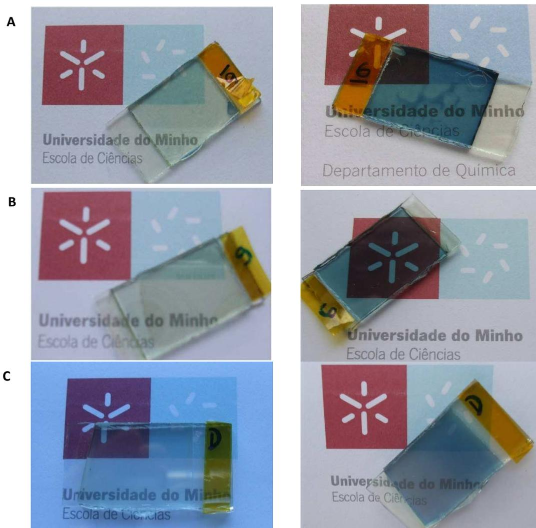
**Figura 46-** Protótipo de janelas inteligentes das amostras de SPEs  $d-U(2000)_nLiXF_6$ : A-  $n=8$   $X=As$ , B-  $n=20$   $X=As$ , C-  $n=15$   $X=Sb$  nos estados transparente e colorido (da esquerda para a direita).
