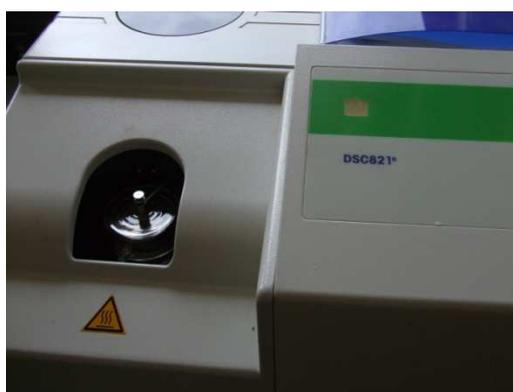
**Figura 29-** Equipamento DSC utilizado, Mettler Toledo DSC 821e.
