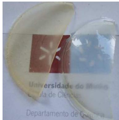
**Figura 57-** SPEs baseados na matriz híbrida d-U(600) cuja composição é d-U(600)<sub>25</sub> LiSbF<sub>6</sub> e d-U(600)<sub>200</sub> LiAsF<sub>6</sub>, (da esquerda para a direita).
