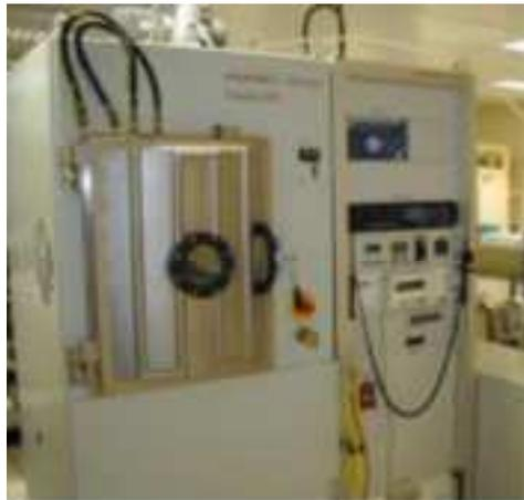
**Figura 43-** Imagens do sistema de pulverização catódica por rádio frequência (13,56 MHz), assistida por magnetron, CENIMAT/I3N.
