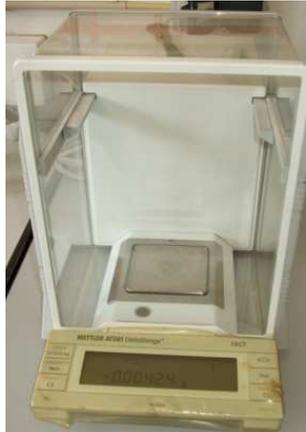
**Figura 6**-Balança analítica Mettler Toledo, AT 261.
