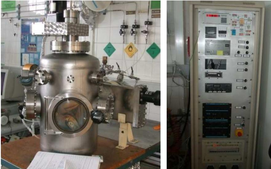
**Figura 41-** Imagens do sistema de pulverização por rádio frequência assistida por magnetrão, CENIMAT/I3N
