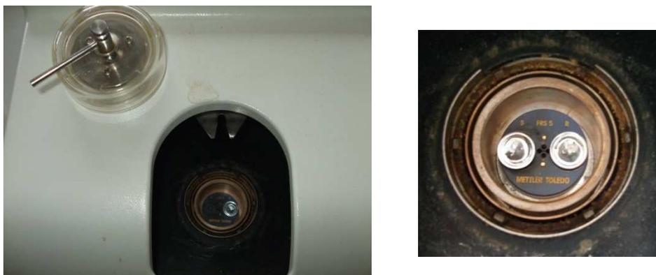
**Figura 31-** Imagens do forno do equipamento DSC utilizado, com os seus cadinhos.
