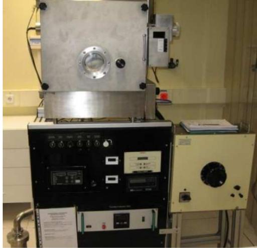
**Figura 42-** Imagens do sistema de evaporação térmica resistiva, CENIMAT/I3N.
