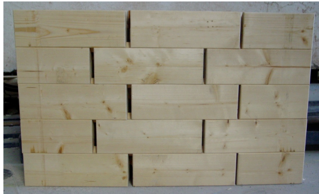
Figura 1.5 - Alvenaria estrutural em madeira (Silva et al., 2011)
