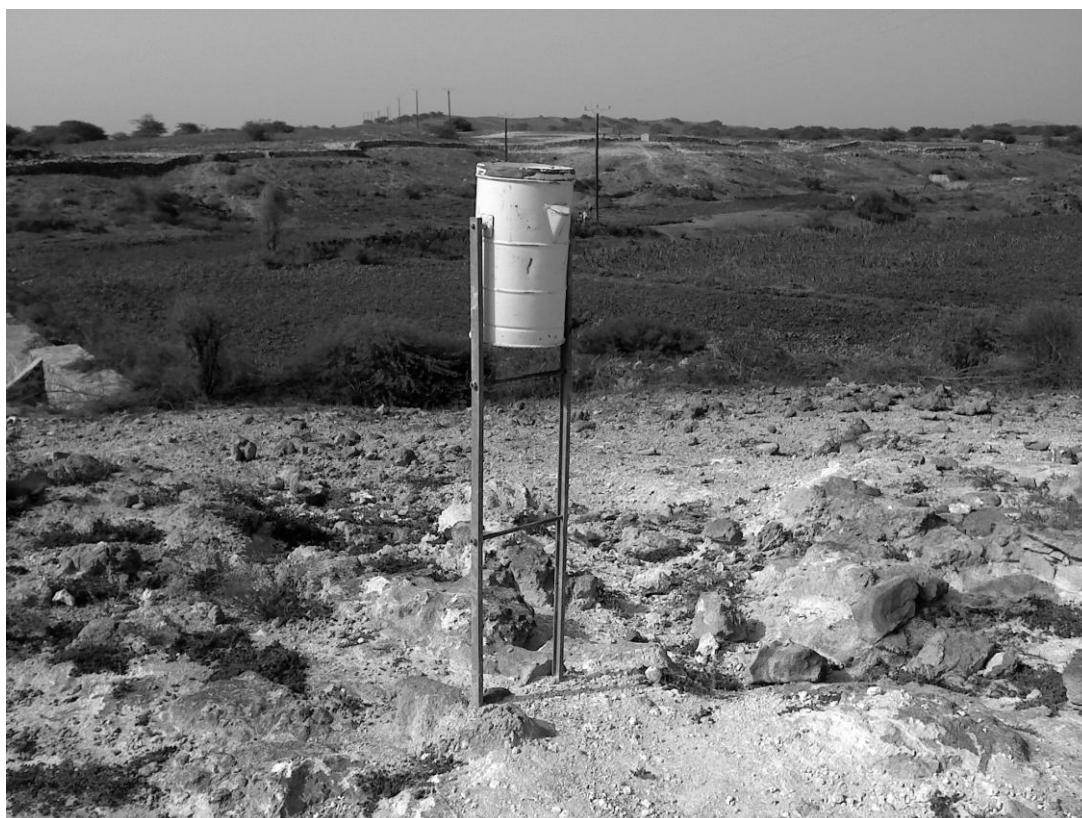
Figura 3.1. Aspecto de uma estação udométrica incluída na rede climatológica da ilha do Maio.
