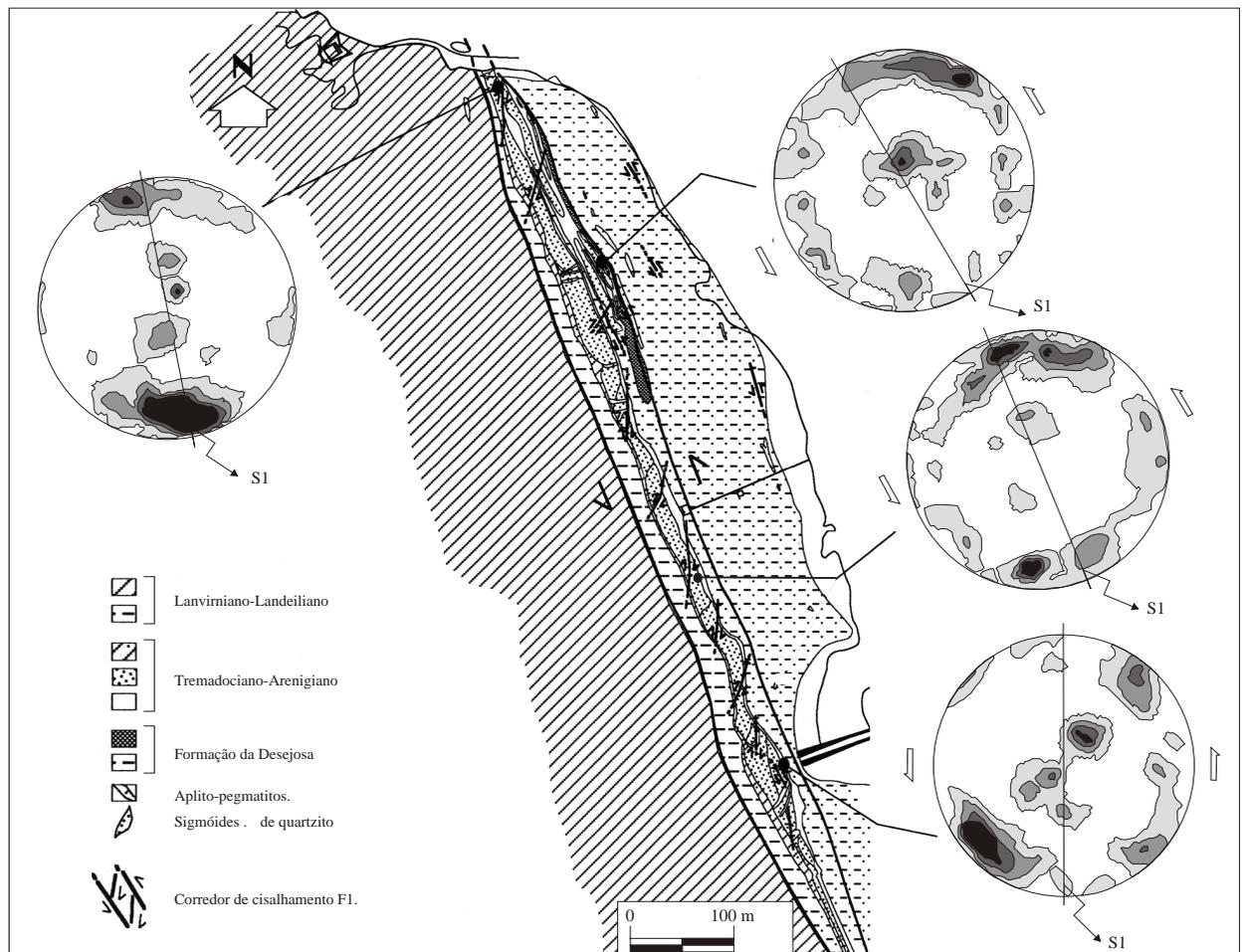
Figura.IV.23- Esboço geológico do sector 2 Praia Norte com as projecções estereográficas dos eixos-c de quartzo. As observações foram feitas paralelamente à direcção da foliação e à lineação de estiramento (X).
