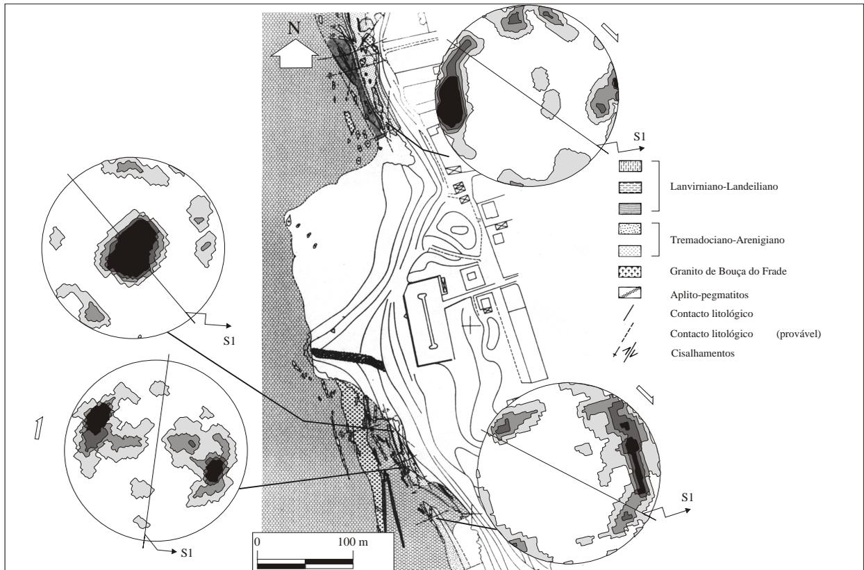
Figura.IV.22- Esboço geológico do sector 1 - Carreço com as projecções estereográficas dos eixos-c de quartzo. As observações foram feitas perpendicularmente à direcção da foliação e paralelamente à lineação de estiramento (X).
