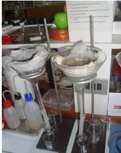
Figura 2 – Esquema da montagem dos funis de Baermann para a clarificação final das suspensões de nemátodes obtidas por sedimentação e crivagem.
