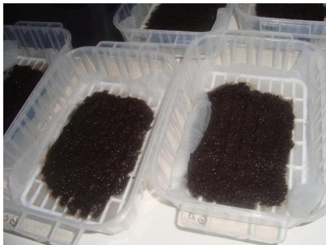
Figura 3 – Tabuleiros montados com solo para a extracção dos nemátodes.
