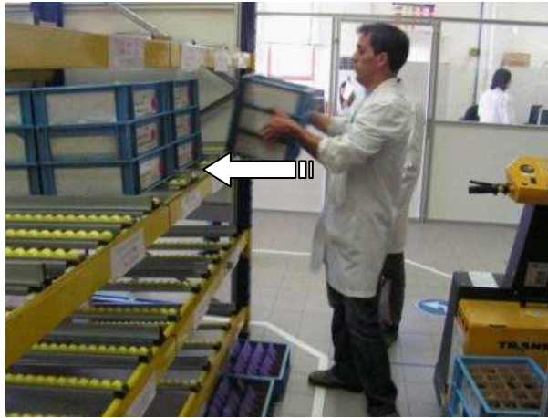
Figura 42 - Colocação das caixas de produto acabado no supermercado
