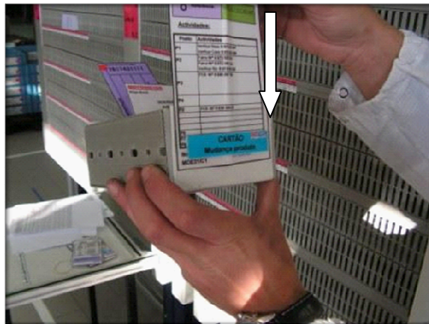
Figura 28 – Colocação do cartão de mudança na caixa de recolha de kanban de movimentação
