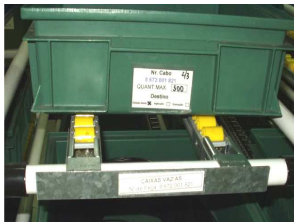
Figura 41 - Rampa de retorno do supermercado de pré-preparações
