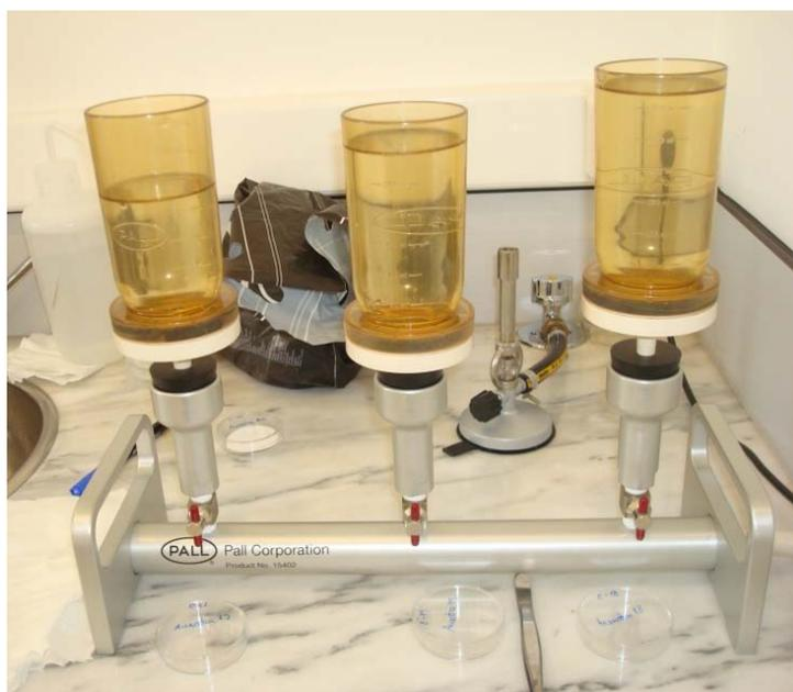
**Figura 17** – Sistema de filtração usado no laboratório da empresa de engarrafamento de água.
