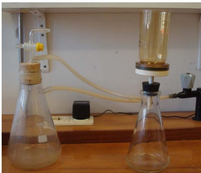
**Figura 18** – Sistema de filtração usado no Laboratório de Águas do Departamento de Ciências da Terra da Universidade do Minho.
