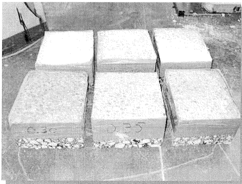
Figura 3 – Lajes preenchidas com calda de cimento
