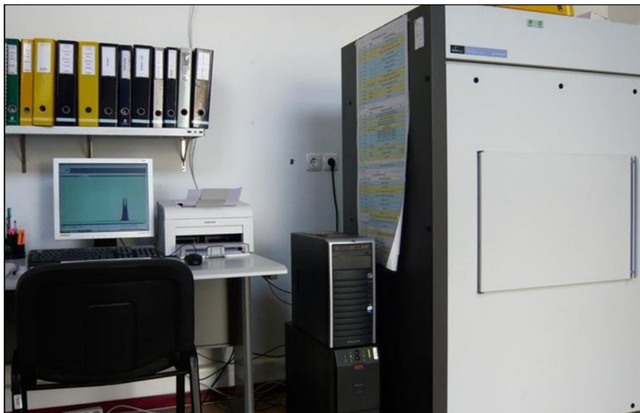
Figura IV.3 - Espectrómetro de cintilação líquida ultra-sensível Perkin Elmer Quantulus 1220, para determinação de um amplo conjunto de radionuclídeos naturais ( ^{238}\text{U} , ^{234}\text{U} , ^{222}\text{Rn} , ^{222}\text{Ra} , ^{226}\text{Ra} , ^{14}\text{C} ...) e artificiais ( ^{137}\text{Cs} , Sr, ^3\text{H} ...), bem como da radiação alfa total e beta total. (Fonte: http://www.dct.uc.pt ).
