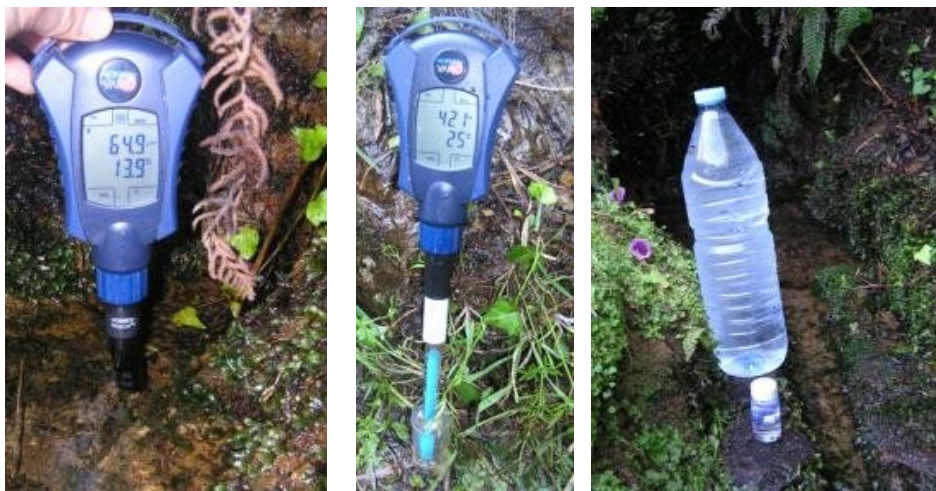
Figura IV.2 – Medição da temperatura e condutividade eléctrica (A), potencial redox (B) e amostra no vial e na garrafa de PET de 1,5 L (C).
