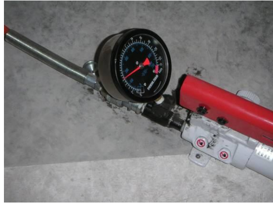
Figura 14. Aplicação da força nos laminados
