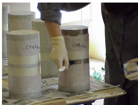
Figura 4 – Aplicação do primário nas zonas de fixação das faixas.
