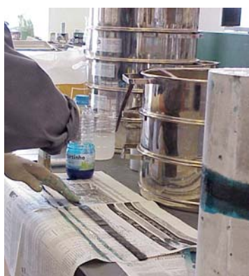
Figura 6 – Aplicação da resina nas faixas de manta.
