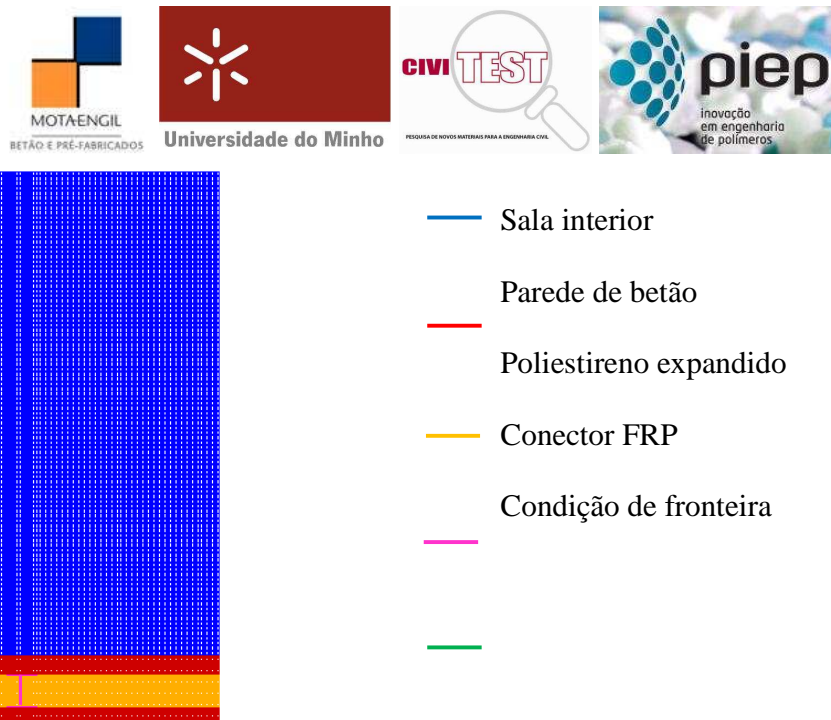
Figura 43 – Malha adoptada no estudo do painel sandwich com conector perfil I colado de FRP e espessura da camada de betão de 60 mm.
