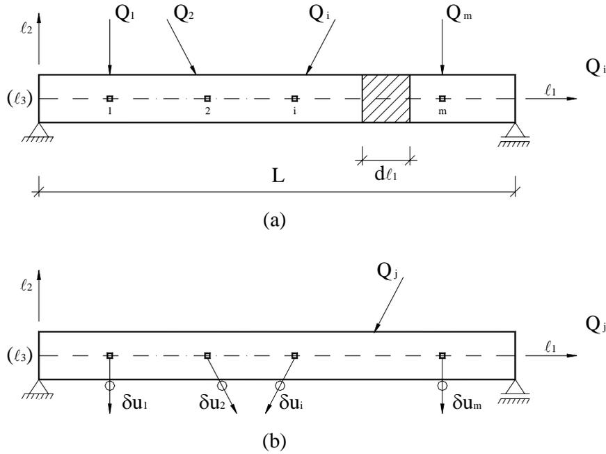
Figura 4.13 – Viga submetida a um conjunto de forças  $Q_i$  (a) e  $Q_j$  (b).
