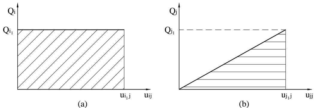
Figura 4.23 – Trabalho produzido pelo sistema de forças  $Q_i$  durante a deformação devida ao sistema de forças  $Q_j$
