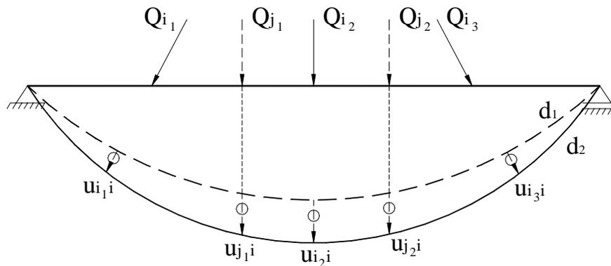
Figura 4.25 – O sistema de forças  $Q_i$  introduz um acréscimo de deformação na viga já sujeita ao sistema de forças  $Q_j$ .
