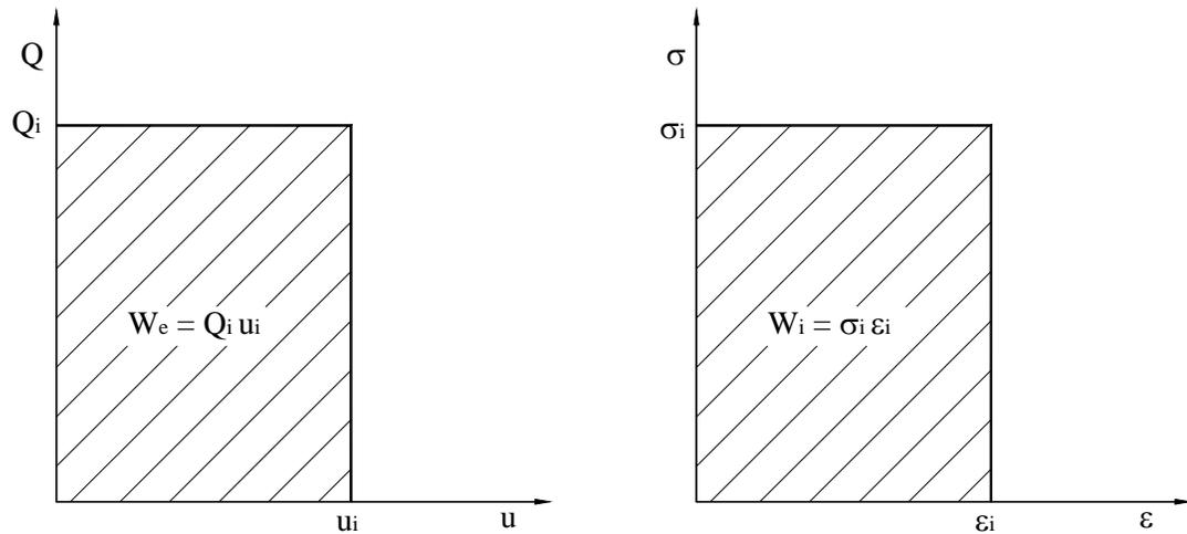
Figura 4.19 – Trabalho externo (a) e interno (b) quando as acções são aplicadas como seu valor final. Representação a uma dimensão.
