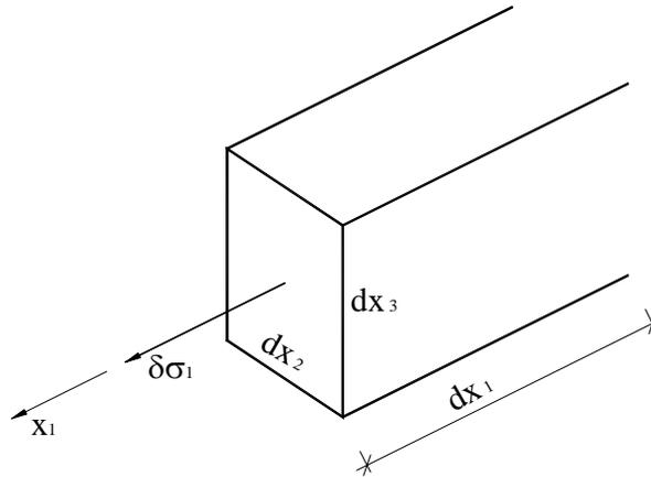
Figura 4.16 – Elemento de volume  $dV = dx_1 dx_2 dx_3$  submetido a variação de tensão  $\delta\sigma_1$ .
