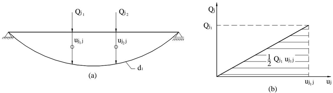
Figura 4.24 – Deformação de viga sob um sistema de forças  $Q_j$  (a) e representação do trabalho produzido por uma componente de força do sistema  $Q_j$  (b).
