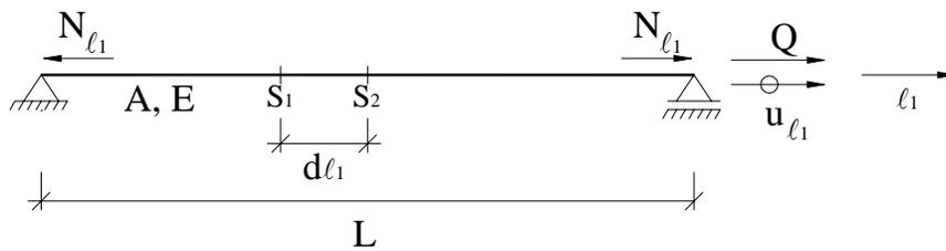
Figura 4.2 – Barra biarticulada de comprimento  $L$ , módulo de elasticidade  $E$  e secção transversal de área  $A$ .
