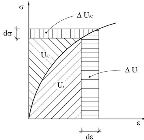
Figura 4.12 - Energia de deformação (representação a uma dimensão).
