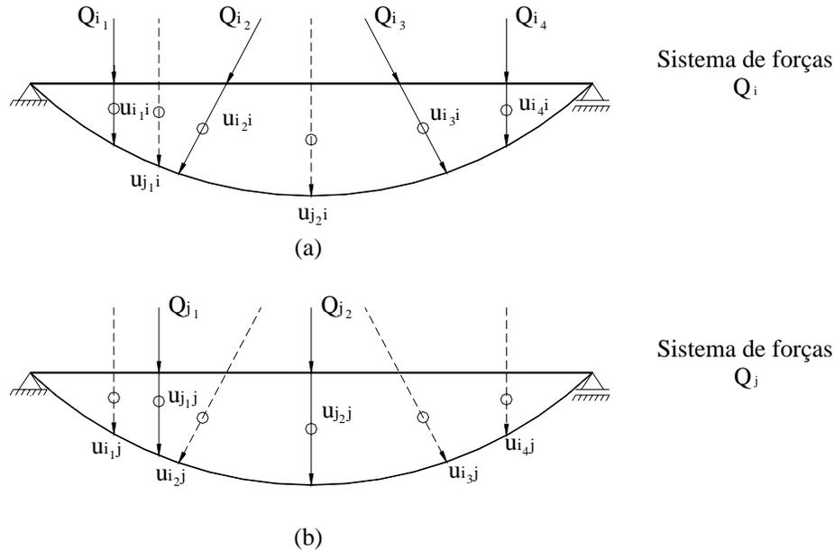
Figura 4.20 – Deformação de viga sob um sistema de forças  $Q_i$  (a) e  $Q_j$  (b).
