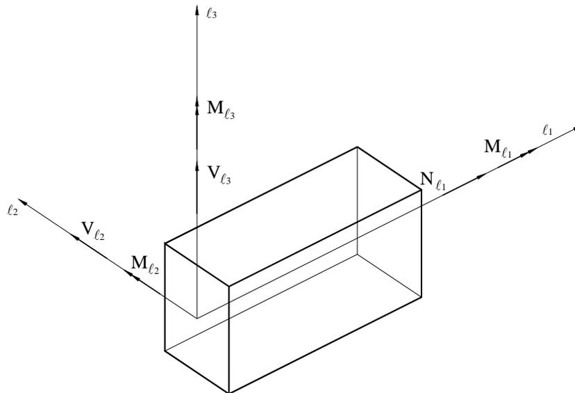
Figura 4.40 - Componentes de esforços que actuam numa barra de pórtico espacial.
