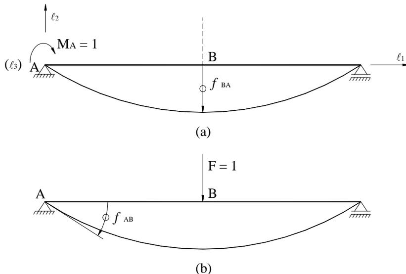
Figura 4.28 – Viga submetida a momento aplicado na secção A (a) e força aplicada na secção B (b).
