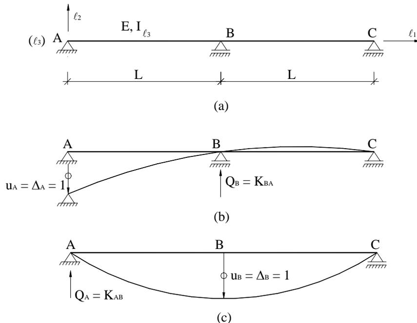
Figura 4.30 – Exemplo de aplicação do teorema da reciprocidade das forças.
