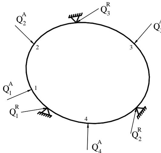
Figura 4.34 – Corpo submetido a forças de acção,  $Q_i^A$ , e de reacção,  $Q_i^R$ .
