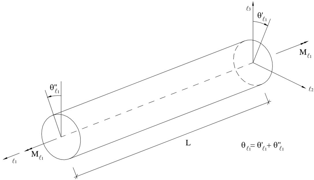
Figura 4.9 - Barra de secção circular submetida a torsão.
