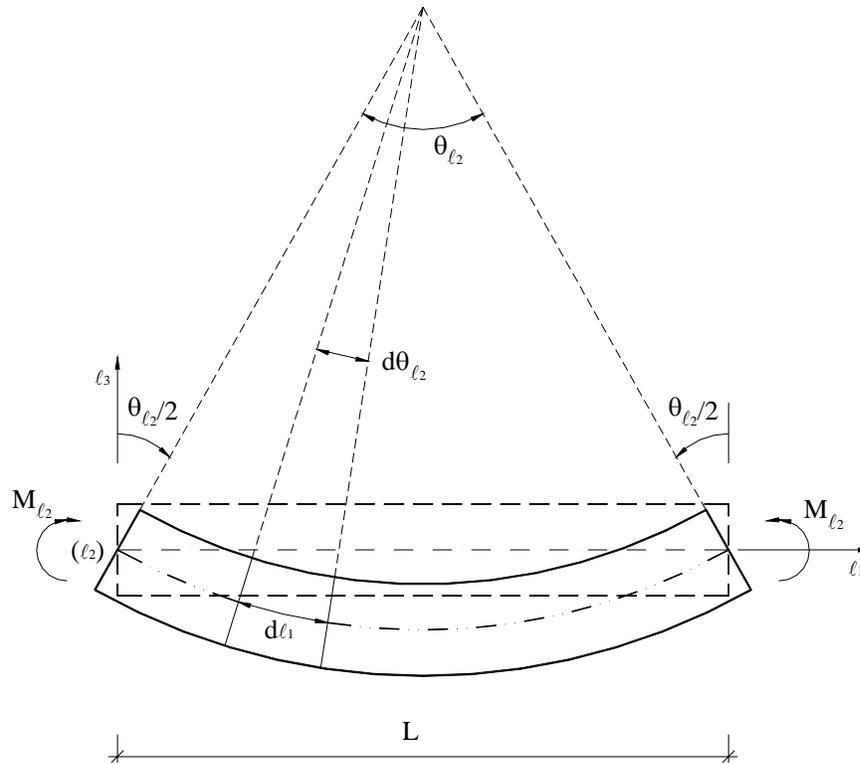
Figura 4.7 - Flexão da barra no plano  $l_1 l_3$ .
