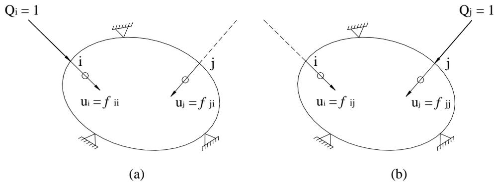
Figura 4.27 – Configuração de equilíbrio  $Q_i=1$  (a) e  $Q_j=1$  (b).
