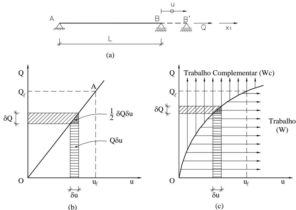
Figura 4.1 - A barra submetida à força axial  $Q$  (a) pode desenvolver uma relação  $Q-u$  não linear (b) ou linear (c).
