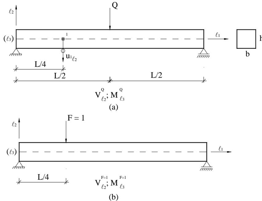
Figura 4.14 – Deslocamento  $u_2$  devido à actuação da carga  $Q$ .
