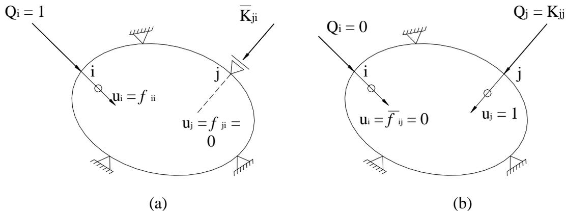
Figura 4.31 – Configuração de equilíbrio  $Q_i=1$ ,  $u_i = f_{ii} \neq 0$ ,  $\bar{k}_{ji} \neq 0$  e  $u_j=f_{jj}=0$  (a). Configuração  $u_j=1$ ,  $Q_j = k_{jj} \neq 0$ ,  $u_i = \bar{f}_{ij} \neq 0$ , e  $Q_i=0$  (b).
