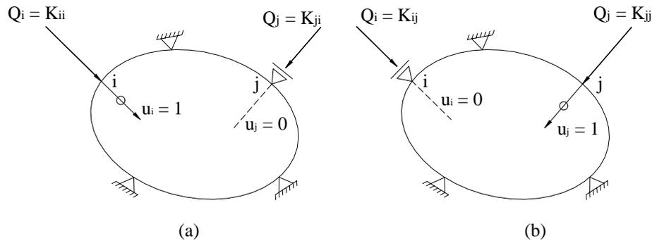
Figura 4.29 – Configuração de equilíbrio  $u_i = 1$  e nulos os restantes deslocamentos (a) e  $u_j = 1$  e nulos os restantes deslocamentos (b).
