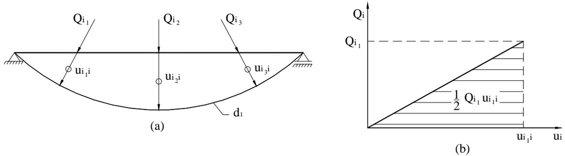
Figura 4.21 – Deformação de viga sob um sistema de forças  $Q_i$  (a) e representação do trabalho produzido por uma componente de força do sistema  $Q_i$  (b).
