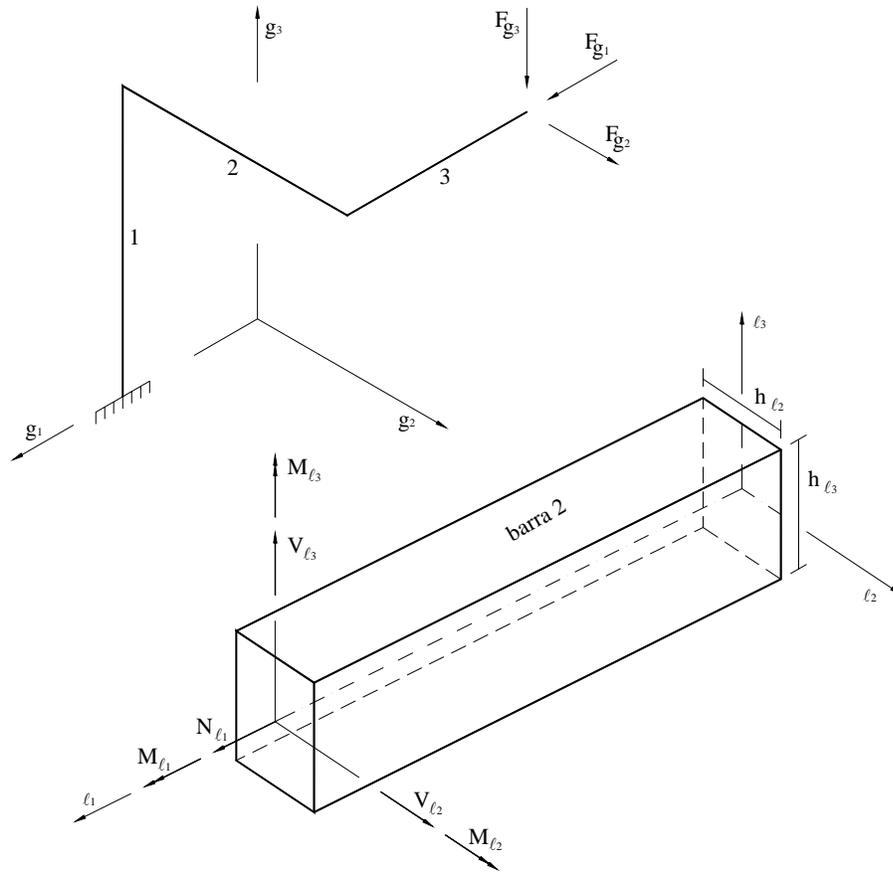
Figura 4.11 - Barra de pórtico contínuo tridimensional.
