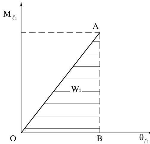
Figura 4.10 - Trabalho interno produzido durante a torção de uma barra.
