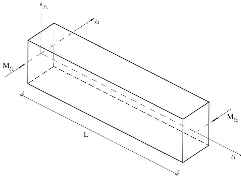
Figura 4.6 - Barra submetida a um par de momentos  $M_2$  nas suas extremidades.
