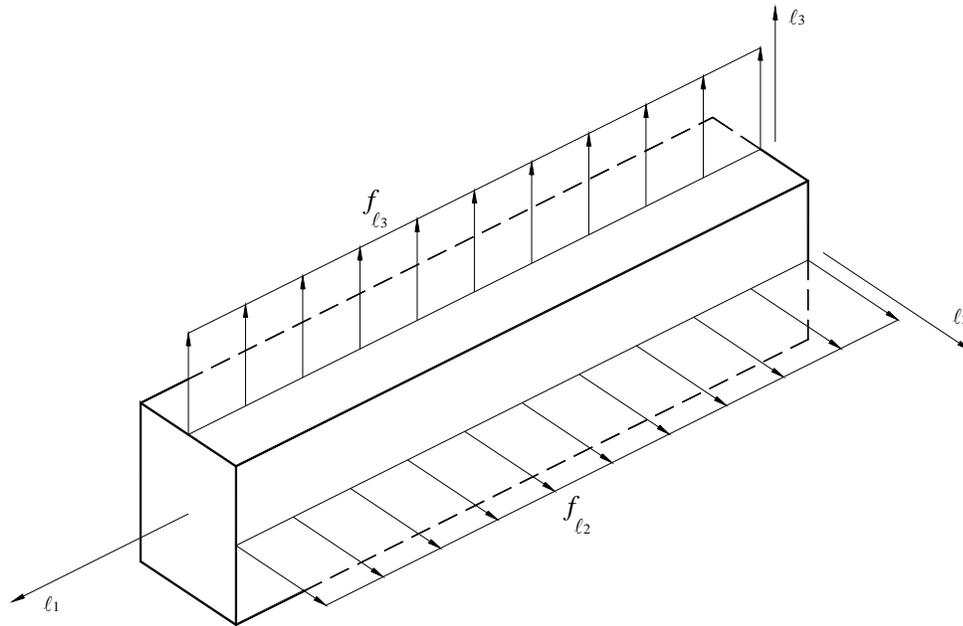
Figura 4.4 – Elemento de barra submetido a forças distribuídas por unidade de comprimento segundo o eixo  $\ell_2$ ,  $f_{\ell_2}$ , e segundo o eixo  $\ell_3$ ,  $f_{\ell_3}$ .
