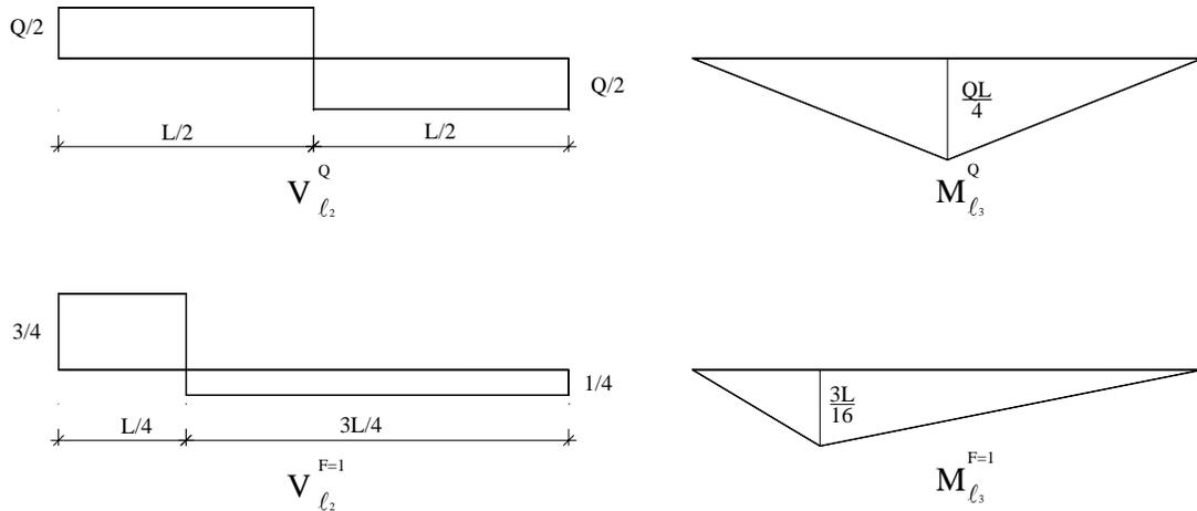
Figura 4.15 – Diagramas de esforços devidos à actuação da carga  $Q$  (a) e  $F=I$  (b).
