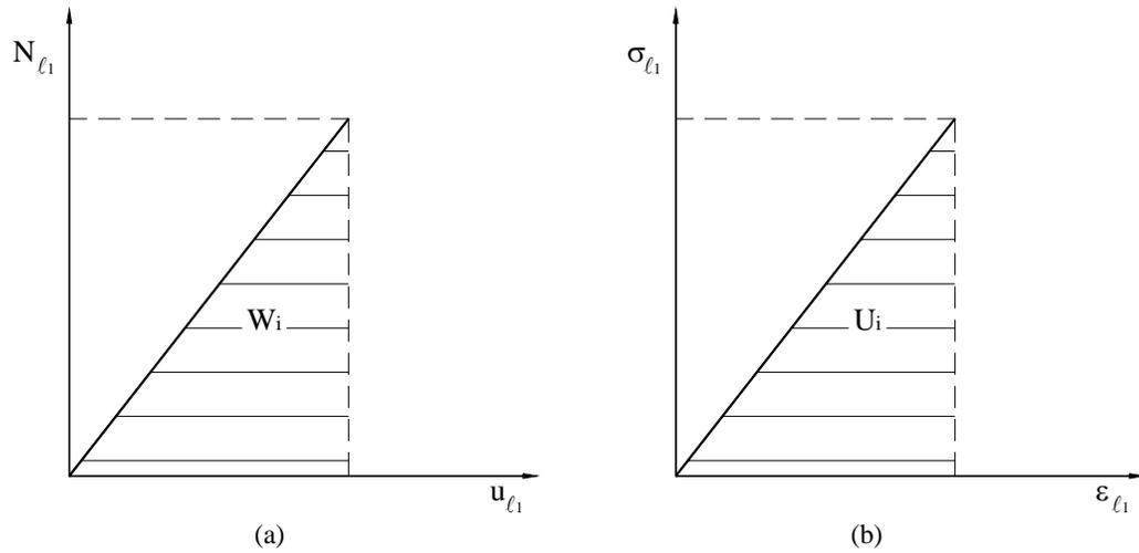
Figura 4.3 – Trabalho interno (a) e energia (b) produzidos durante a deformação axial de uma barra biarticulada com comportamento linear-elástico.
