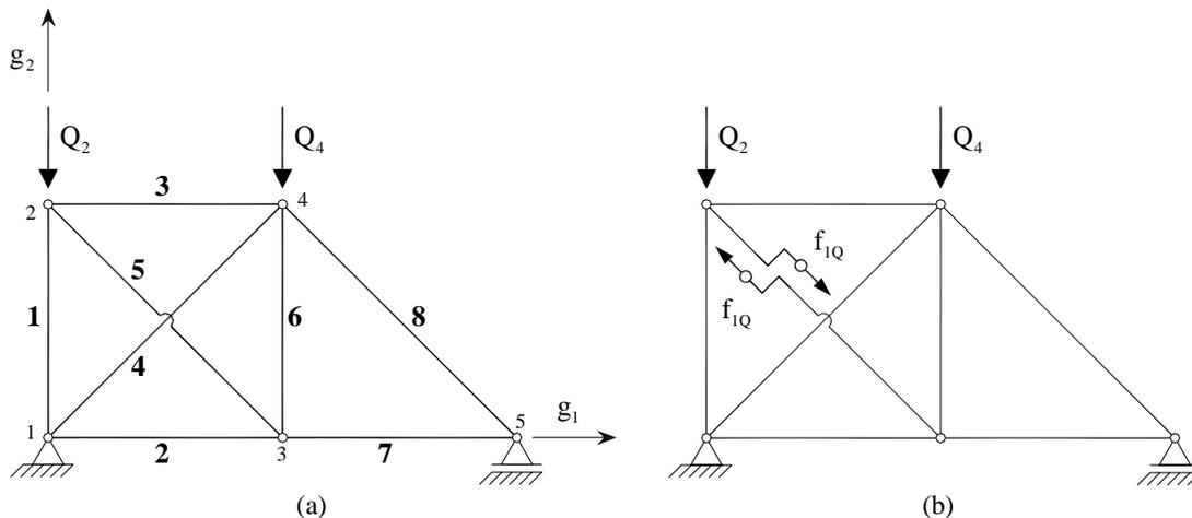
Figura 4.47 - Aplicação do teorema de Manabrea na determinação do valor de incógnitas hiperestáticas.
