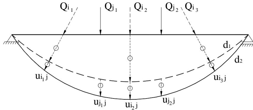
Figura 4.22 – O sistema de forças  $Q_j$  introduz um acréscimo de deformação na viga já sujeita ao sistema de forças  $Q_i$ .
