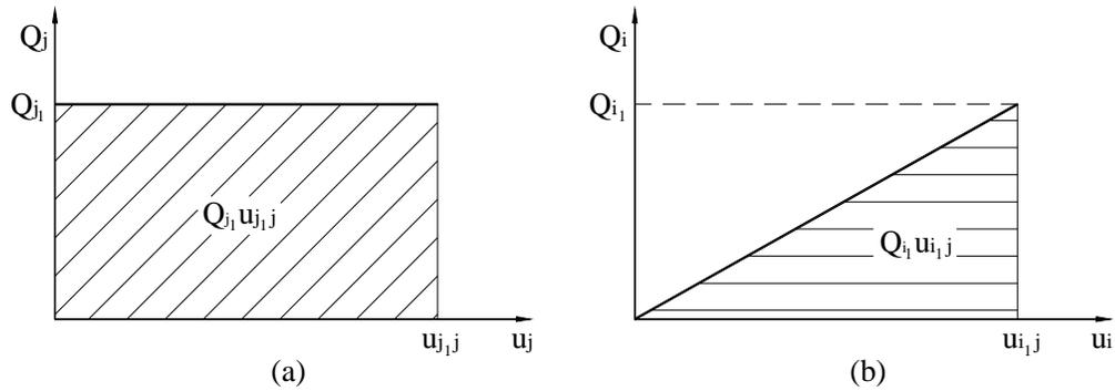
Figura 4.26 – Trabalho produzido pelo sistema de forças  $Q_j$  durante a deformação devida ao sistema de forças  $Q_i$
