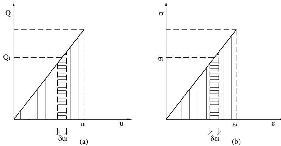
Figura 4.18 – Trabalho externo (a) e interno (b) quando as acções aumentam desde o valor nulo até ao seu valor final. Representação a uma dimensão.
