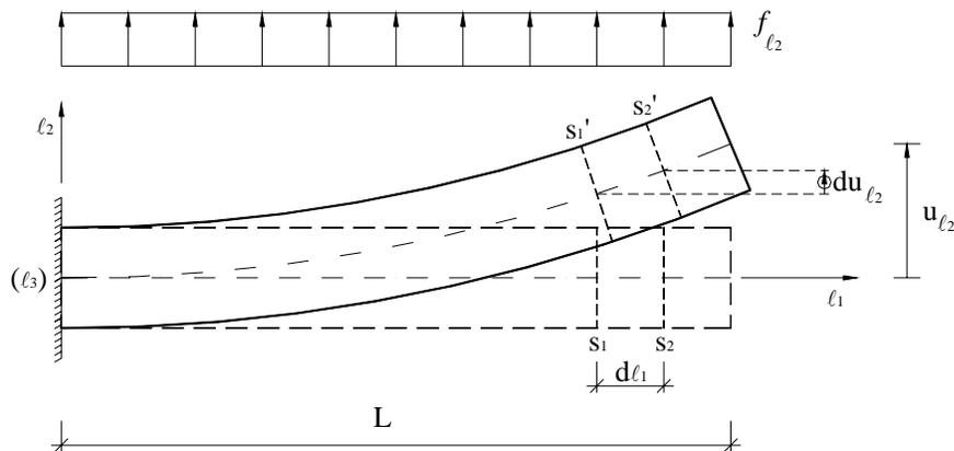
Figura 4.5 – Deformação da barra devido à actuação de  $f_{\ell_2}$ .
