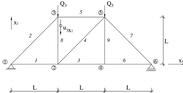
Figura 4.38 - Estrutura articulada plana (barras com módulo de elasticidade  $E$  e secção transversal de área  $A$ ).
