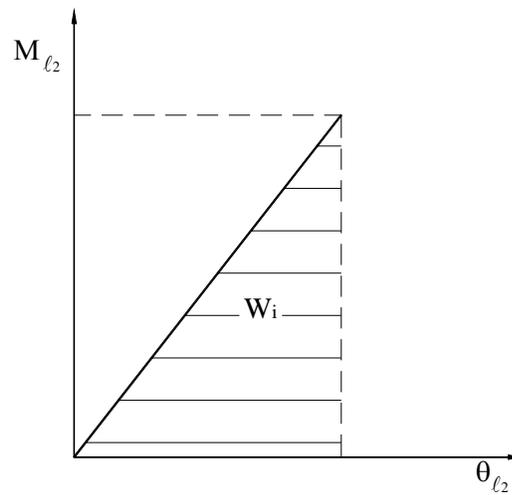
Figura 4.8 - Trabalho interno produzido durante a flexão em torno do eixo  $l_2$  de uma barra (flexão no plano  $l_1 l_3$ ).
