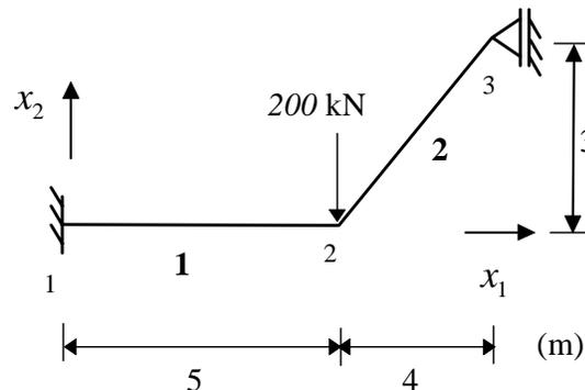
Figura 4.32 – Aplicação do teorema da reciprocidade das forças/deslocamentos.
