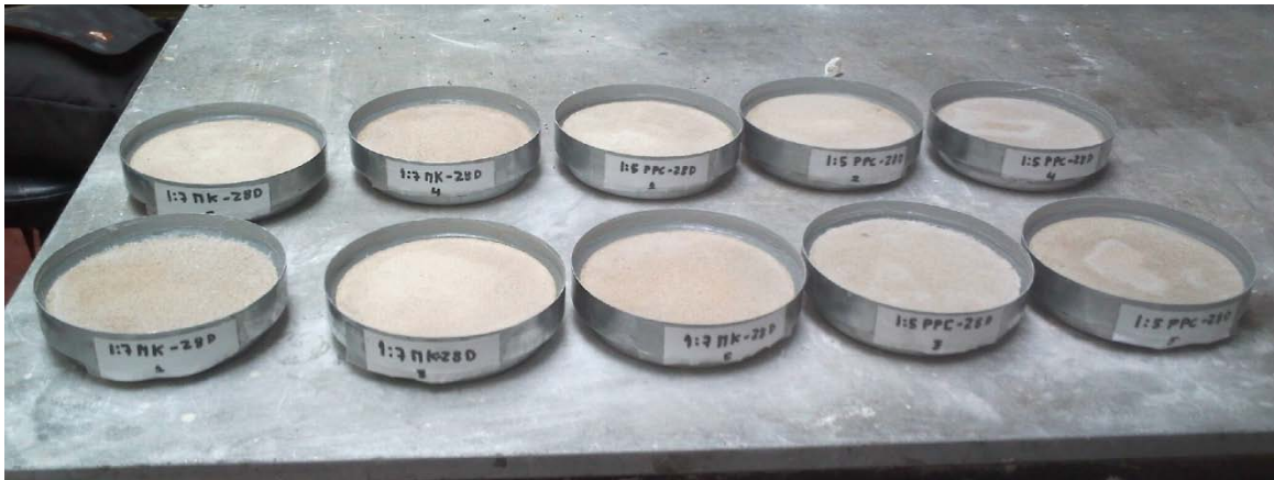
Figura 1 – Copos de ensaio no final do ensaio de permeabilidade ao vapor de água
