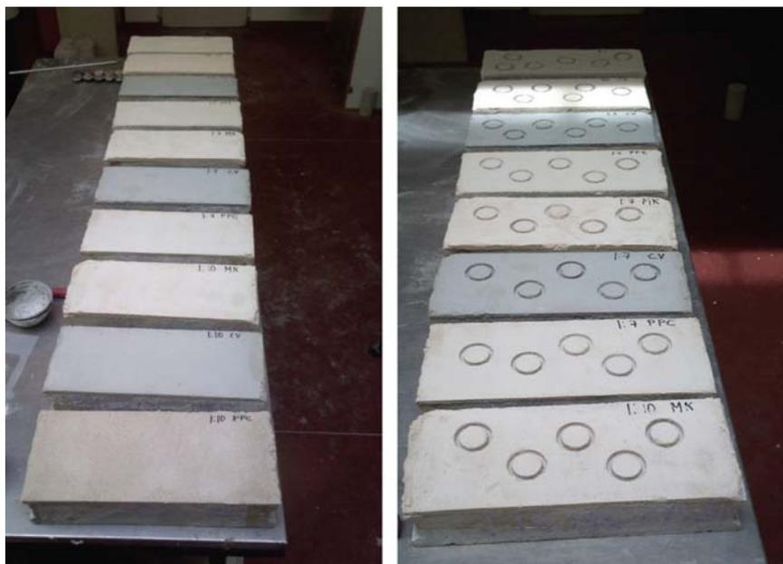
Figura 1 – Provetes com 28 dias de idade antes e após a carotagem
