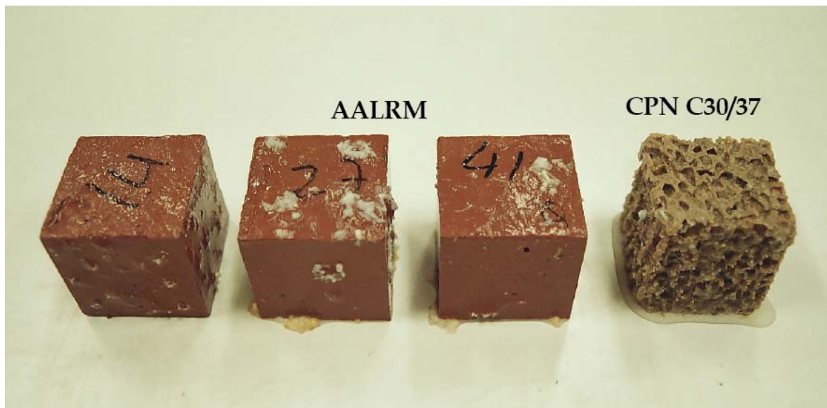
Figura 2 – Provetes de ligantes activados alcalinamente (AALRM) e provetes de betão CPN C30/37 imersos em ácido nítrico. Aspecto ao fim de apenas 24 horas (Torgal et al., 2007)
