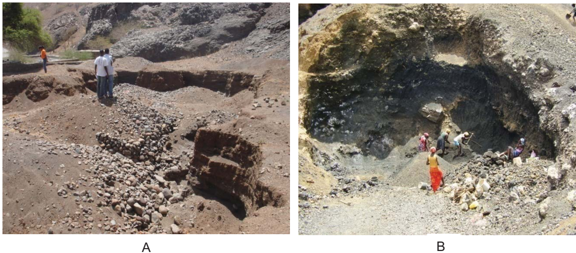
Figura 3. 6 - Exploração de inertes nas aluviões (A- Ribeira de Milho Branco) e de materiais piroclásticos (B -Tarrafal) para a indústria de construção civil - Ilha de Santiago, Cabo Verde.
