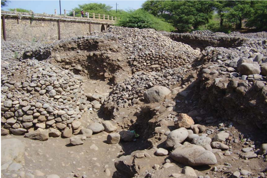
Figura 8. 40 - Zona aluvionar evidenciando o impacte da exploração de inertes na ribeira de Chão Bom, Tarrafal - ilha de Santiago (Ribeiro, 2006).
