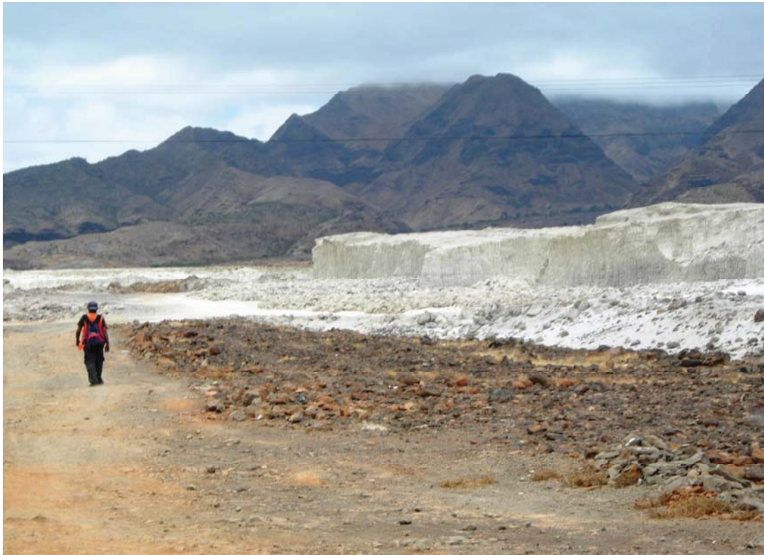
Figura 8. 45 - Pozolanas de Santo Antão. Zona de exploração para fins industriais (fabrico de cimento).
