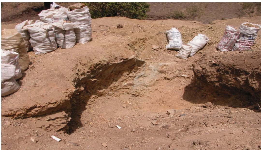
Figura 8. 43 - Exploração de argilas resultantes da alteração da Formação de Assomada para fins industriais em Fonte Lima e confecção de objectos de barro, ilha de Santiago.
