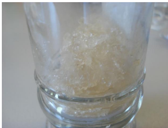
Figura 3.42. Matriz polimérica poli(oximetilenoxietileno), aPEO após purificação com tolueno e hexano.
