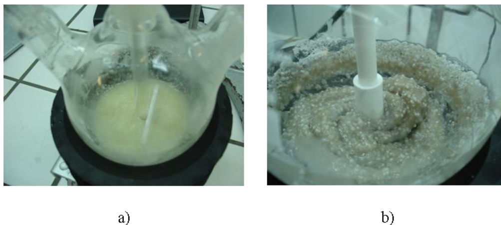
Figura 3.39. Síntese do polímero aPEO em diferentes fases: a) após a adição de PEG400; b) ao fim de 1 h de agitação da mistura reaccional.
