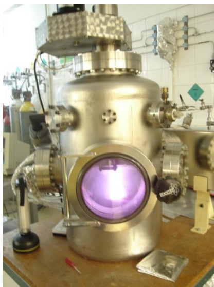
Figura 3.46. Sistema de pulverização catódica por rádio frequência assistida por magnetrão, utilizado na deposição de TCO, existente no laboratório de películas finas do CENIMAT/I3N.
