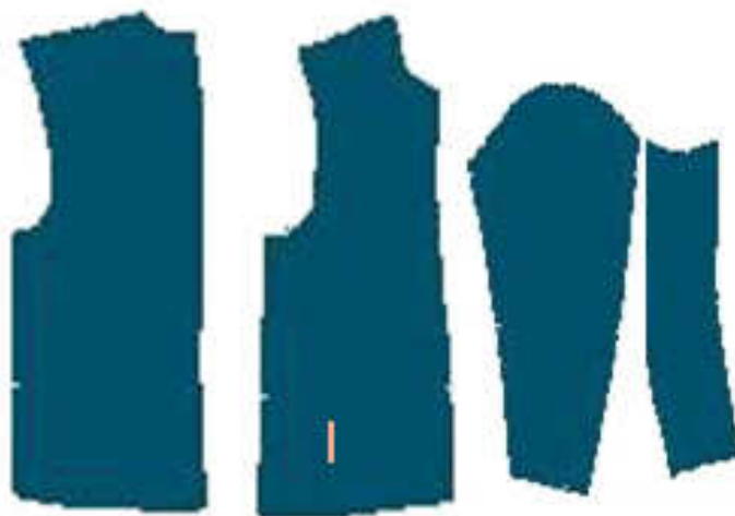
Figura 5.5. Molde base de camisa de homem adaptada à posição de sentado com manga do tipo duas folhas
