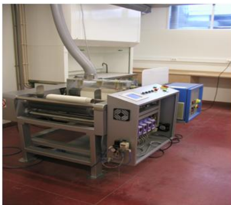
Figura 12 – Protótipo da Máquina de Plasma Softal [Pat. PCT/PT 2004/ 000008(2004)]
