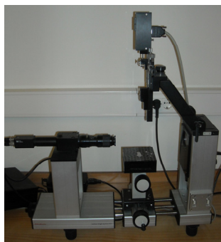
Figura 14 – Aparelho Goniómetro utilizado para medição do ângulo de contacto
