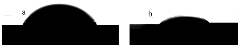
Figura 20 - Contacto de uma gota de água numa amostra com tratamento plasmático a) instante inicial e b) depois de 30 segundos.
