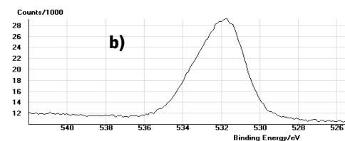
Gráfico 12 - Análise dos picos de carbono O_{1s} , a) amostra com tratamento e b) amostra sem tratamento.
