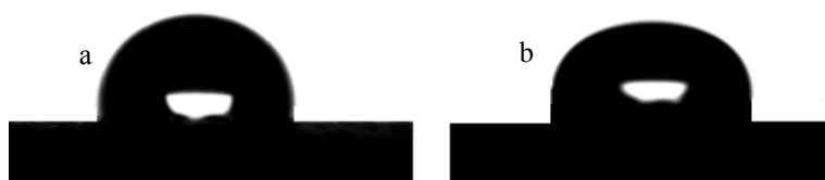
Figura 19 - Contacto de uma gota de água numa amostra sem tratamento plasmático a) instante inicial e b) depois de 30 segundos.
