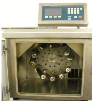
Figura 13 – Máquinas de tingimento utilizadas no decorrer do trabalho.
