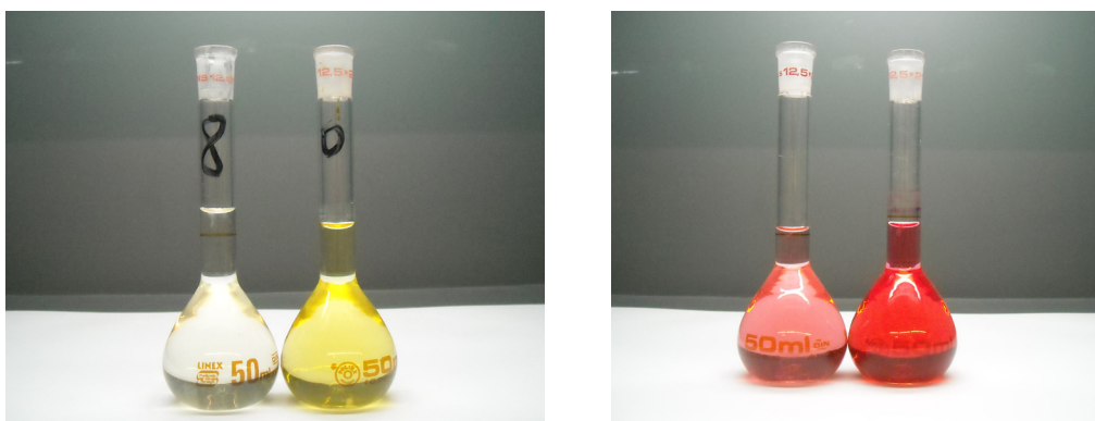
Figura 18 – Comparação do banho residual dos tingimentos com corantes reactivo e directo (soluções mais claras = efluentes das amostras com tratamento, soluções escuras = efluentes das amostras sem tratamento plasmático).
