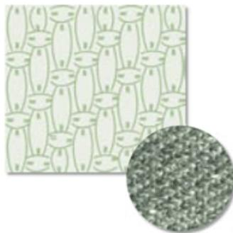
Figura 2.1. Desenho têxtil com efeito de riscado diagonal de uma sarja.
