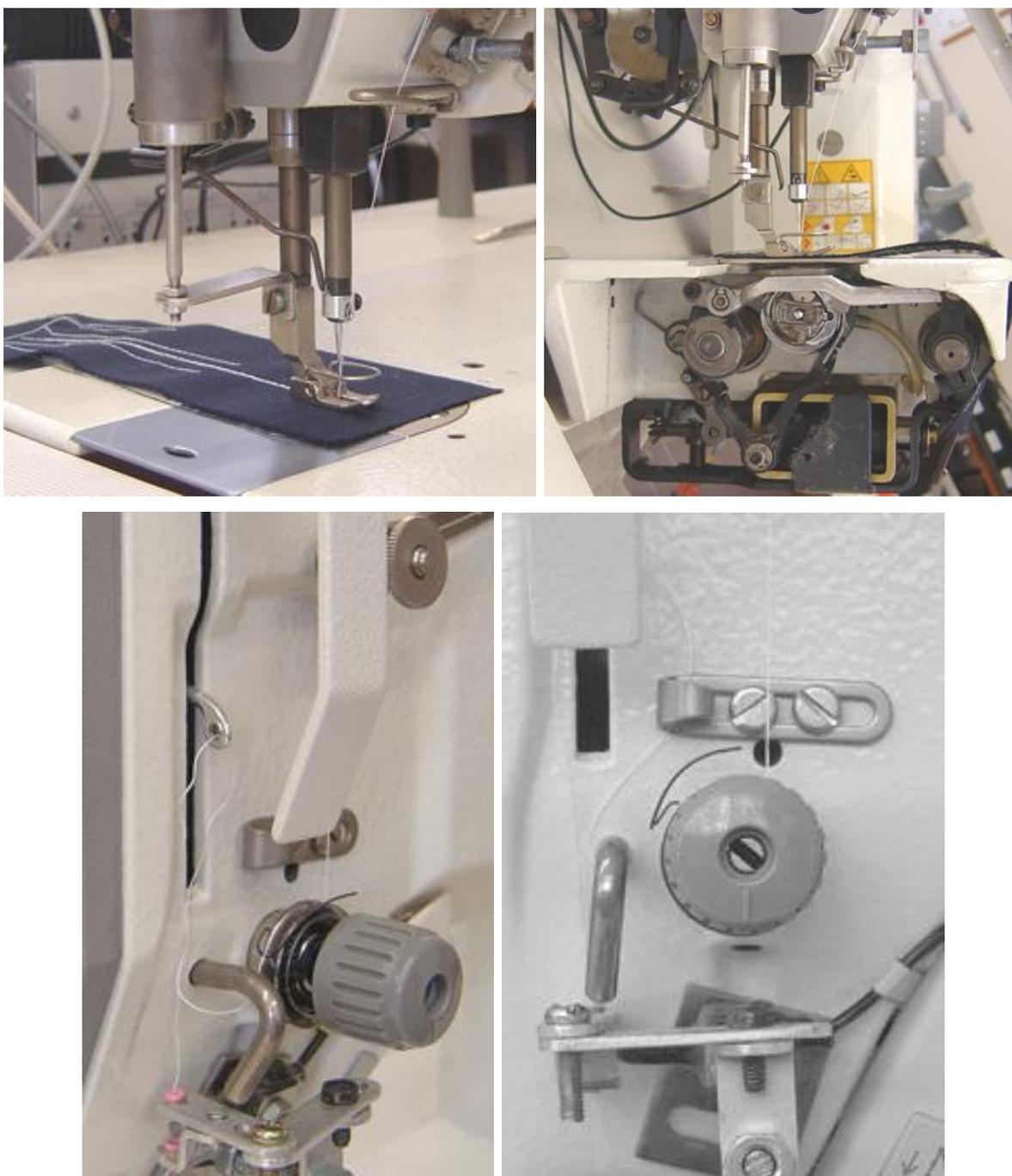
Figura 4.2.1.3. - Posição dos vários elementos aos 150º do ciclo da máquina.
