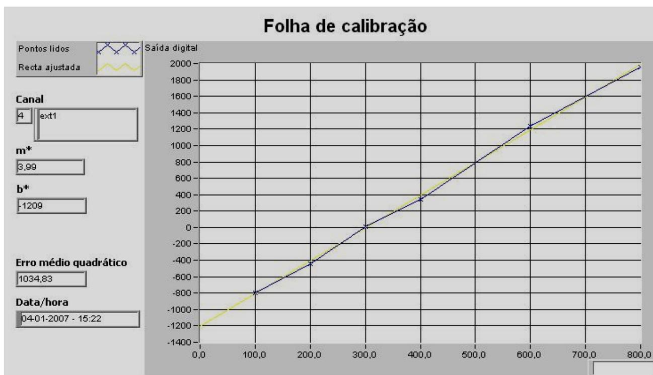
Figura 3.4.1.3. - Método utilizado para calibração do sensor
