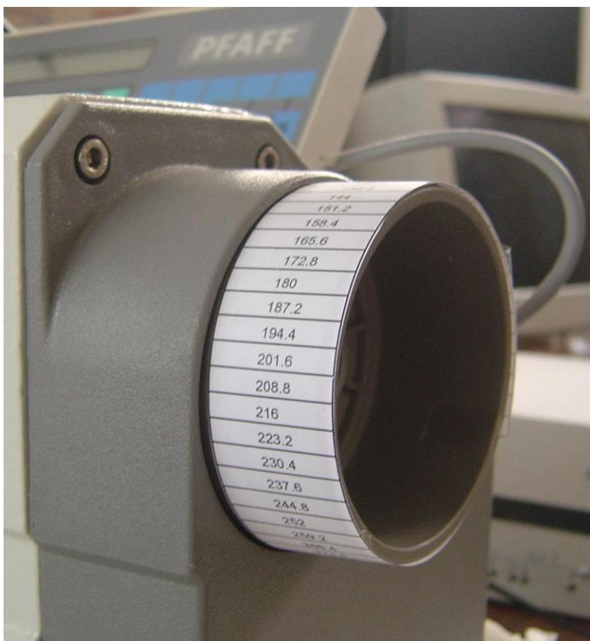
Figura 2.1.3.2 – Escala graduada no volante.
