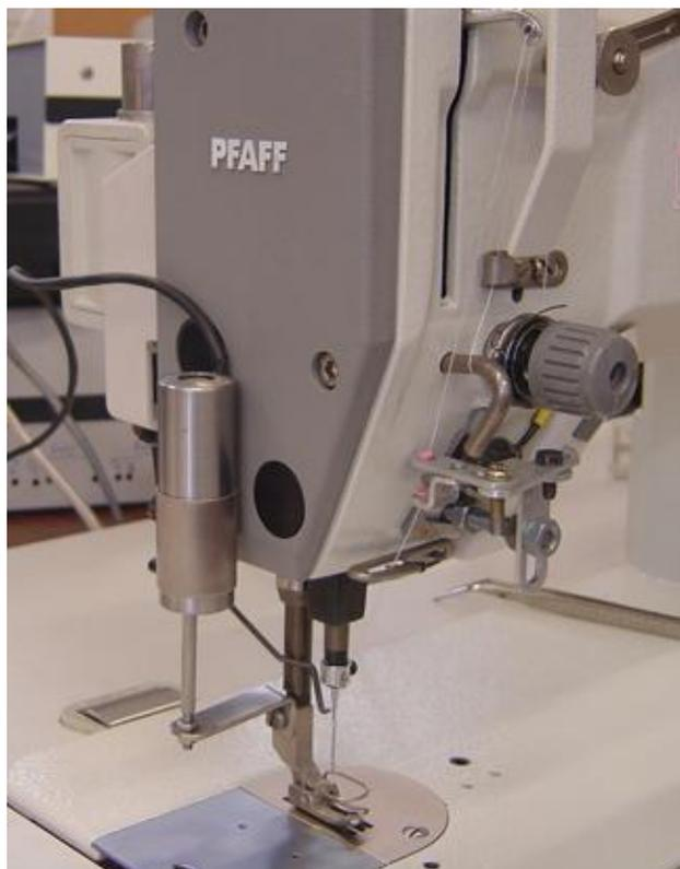
Figura 3.3.5 - LVDT para medição do deslocamento do calcador.
