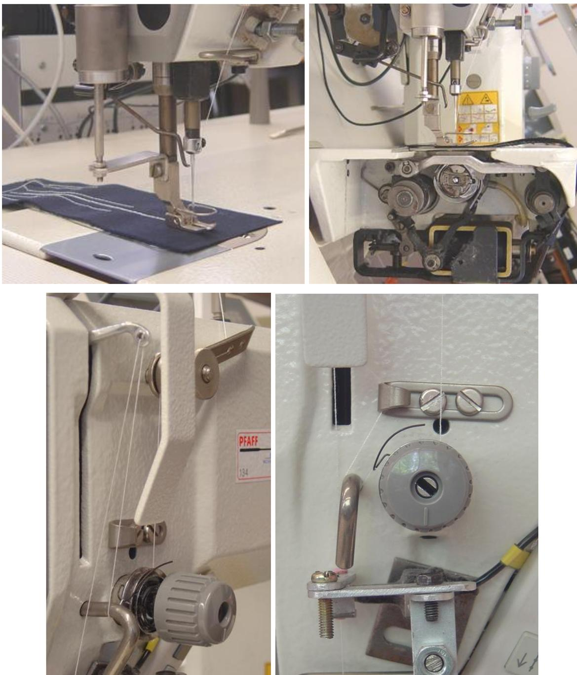
Figura 4.2.1.5. - Posição dos vários elementos aos 305º do ciclo da máquina.
