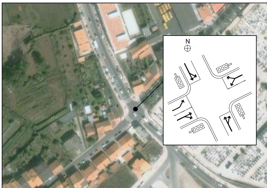
Figura 5.21 – Geometria e movimentos de tráfego da intersecção semafórica
