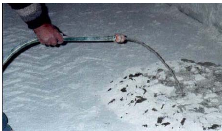
Figura 3: Operação de apagamento da cal [4]
