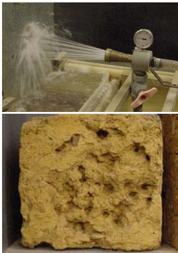
Fig. 2. Ensaio acelerado de erosão Bulletin 5: a) Ensaio; b) Provede erodido (Créditos: Heathcote e Moore, 2003)
