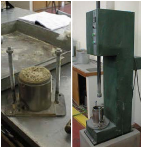
Fig .1. Ensaio de compactação Proctor pesado: a) molde com solo; b) equipamento de compactação.
