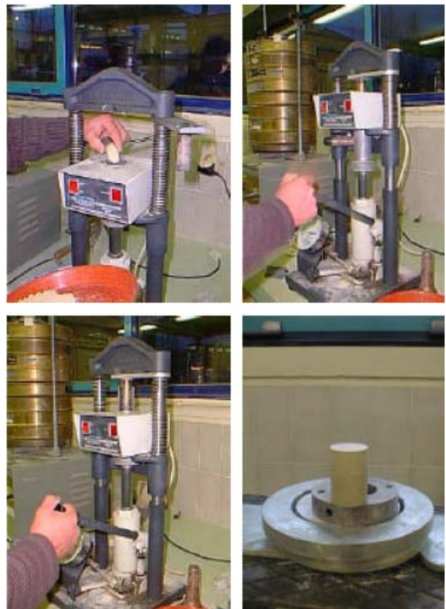
Fig .2. Preparação de um provete de 45x30mm para ensaio à compressão simples [7]
