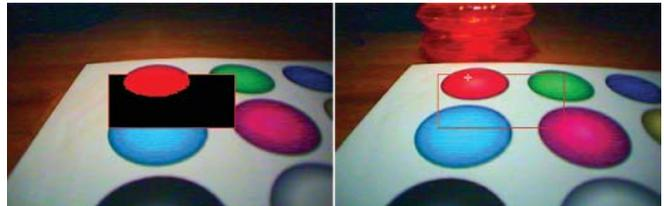
**Figura 4** Utilização de sensor de cor para procurar vermelho: esquerda) visível o filtro (mostra apenas os pixels vermelhos), direita) indica com uma cruz branca a posição do máximo de vermelho
